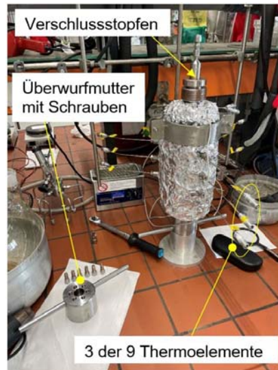
Abbildung 8.1.4 Zweiter Reaktor nach der Befüllung.
