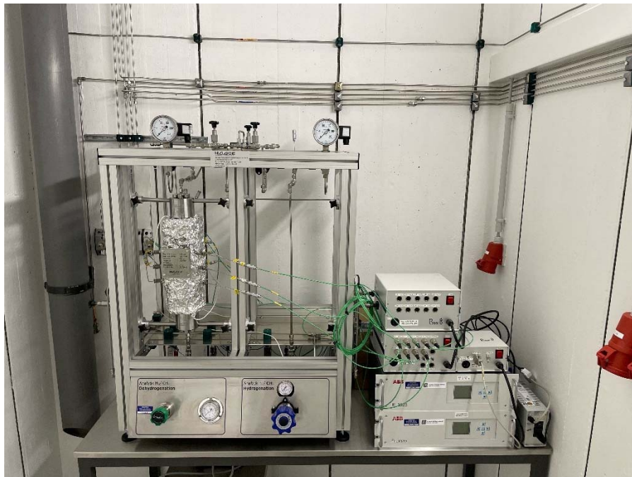
Abbildung 8.2.1 Im Versuchsstand eingebauter erster Reaktor.
