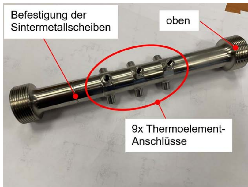
Abbildung 7.4.3 Ansicht des gefertigten Reaktors mit Anschlüssen für 9 Thermoelemente.
