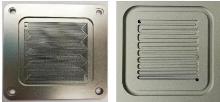
**Abb. 23:** Aufnahmen von zwei aus Titan gefrästen und platiniierten Bipolarhalbplatten für den Einsatz in der Baltic qCf (l. 25cm<sup>2</sup> Fine-Flussfeld, r. 5cm<sup>2</sup> divergierendes Einkanal-Flussfeld).
