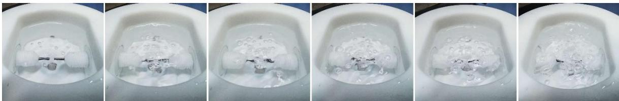
**Abb. 2.** Argon Bläschen erzeugt durch eine keramische Fritte mit Ar- Prozessgasfluss von 50, 100, 200, 300, 400 und 500 sccm.
