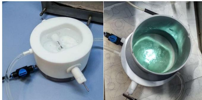
**Abb. 1.** Links: Durchfluss-Batchreaktor für die Graphensynthese. Rechts: während einer Entladung mit 4 kV, Pulslänge von 300 ns und Repetitionsfrequenz von 150 kHz.
