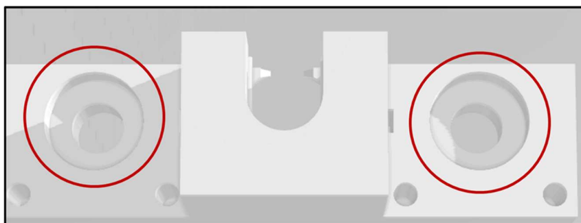
Abbildung 28: Ausschnitt des Kartuschenwechslerkörpers. Rote Markierungen zeigen die Positionen für die Axialkugellager.
