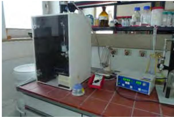
Abbildung 3.3 Ultraschallstab in Schallschutzbox mit Steuereinheit
