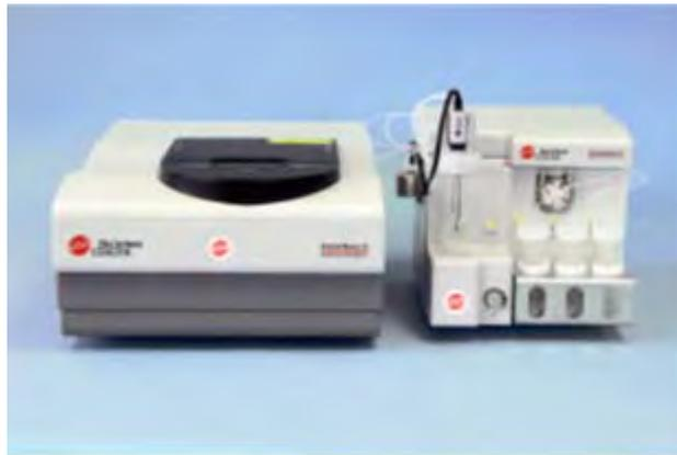
Abbildung 3.1: DELSA Nano C Particle Sizer und DELSA Nano T Autotitrierer, Beckmann Coulter [34]
