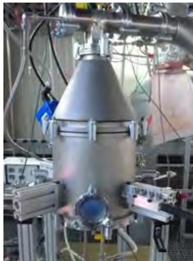
Abbildung 1.5: Flammenreaktor zur  $\text{TiO}_2$ -Nanopartikelsynthese
