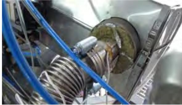
*Abbildung 1.6: Filter mit angeschlossenem Wellenschlauch*
