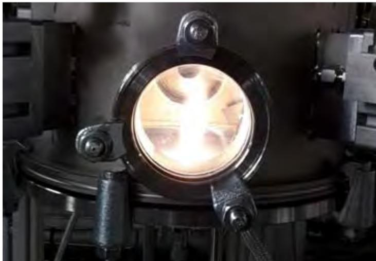
Abbildung 2.4 Brennerflamme während der Synthese von  $\text{TiO}_2$
