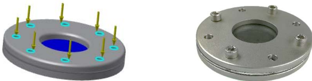
Abbildung 3.1.9: Messzelle im CAD-Modell (links) und ein Foto der Messzelle (rechts)
