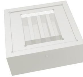
**Abb. 13:** angepasster Entwurf für Mikro-Zersetzungsreaktor angepasst auf die maximal verfügbare Größe an porösem Glasmembransubstrat.
