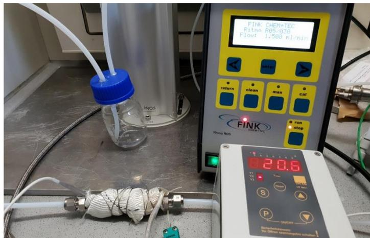
**Abb. 16: Zersetzungsversuchsaufbau mit geheiztem Rohreaktor und Versorgungspumpe.**
