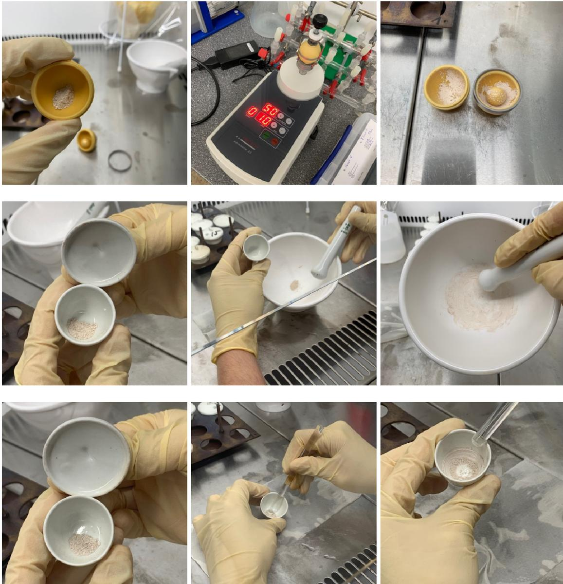
Abbildung 11 Zerkleinerungsprozeduren, oben - mahlen in der Kugelmühle, Mitte – zerreiben im Mörser, unten – zerreiben im Tiegel
