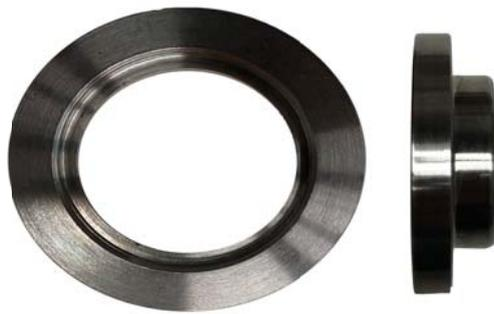
Abbildung 28: Drauf- und Seitenansicht des gefertigten Stutzen nach zur Rohrverbindung als Auflagefläche am Motorauslass im Dachs-BHKW.
