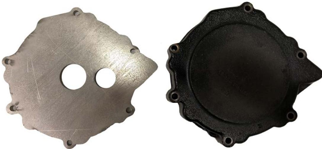
Abbildung 27: Darstellung der Gehäusedeckel. Links der neu konzipierte Gehäusedeckel aus Edelstahl, rechts der am SenerTec Dach serienmäßig verbauter Deckel aus Gusseisen.
