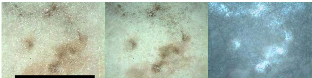
*Abb. 12: Mikroskopische Aufnahmen eines Öltransportkanals (Medium G); die gleiche Stelle in unterschiedlichen Aufnahmemodi (von links nach rechts): Auflicht, Dunkelfeld, Durchlicht*
