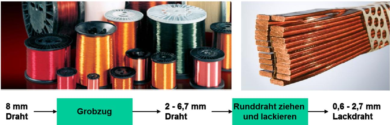
**Bild 16** Produkte (oben) und Produktionsprozess (unten) bei der Kupferlackdrahtherstellung
