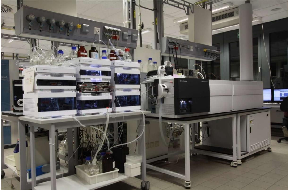
Abbildung 32: Kopplung des 2D-LC-Systems mit dem hochauflösenden Massenspektrometer im Labor der Forschungseinrichtung 2.
