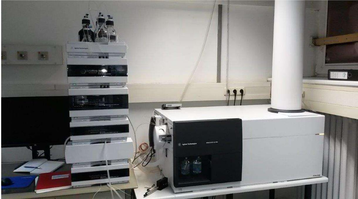
Abbildung 39: HPLC-HRMS-Kopplung im Labor der Forschungseinrichtung 1. Linke Bildseite: LC 1260 der Firma Agilent; rechte Bildseite: 6545 QTOF der Firma Agilent.
