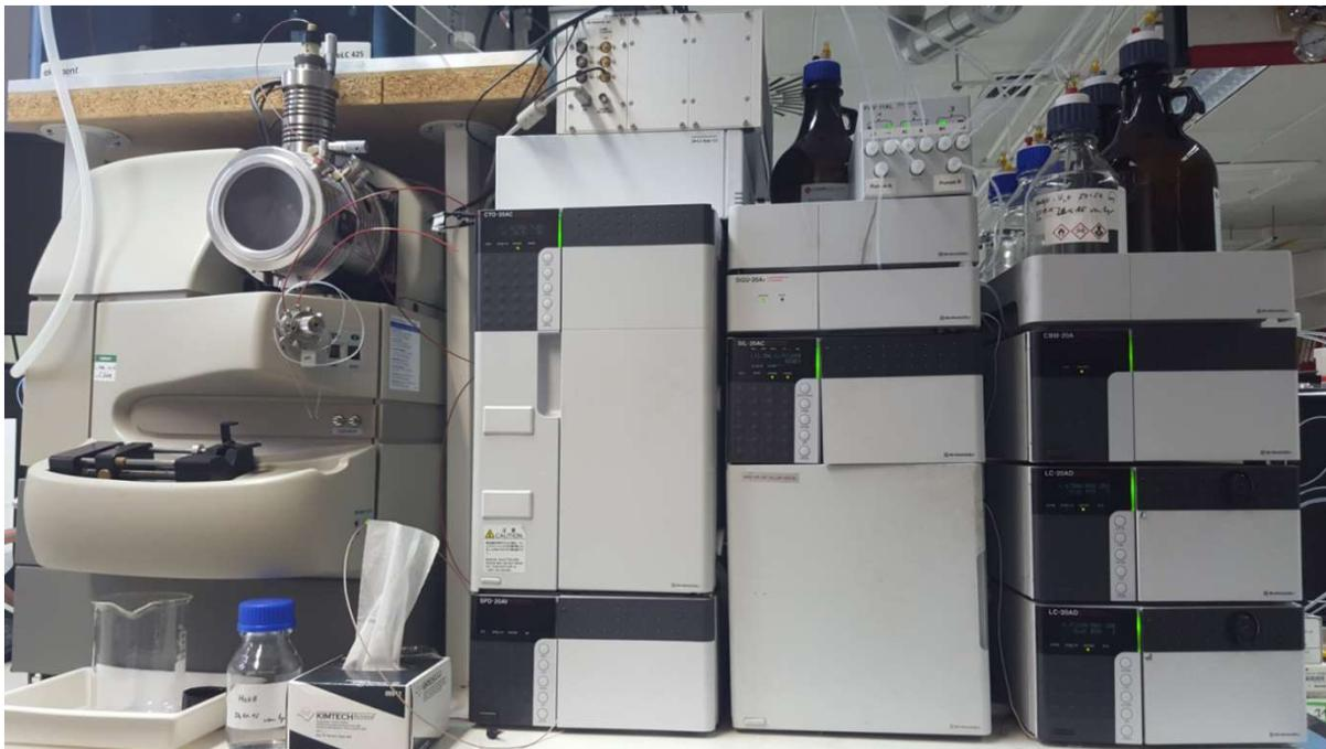
Abbildung 7: HPLC-MS-Kopplung im Labor der Forschungseinrichtung 1. Rechte Bildseite: LC 20 AD der Firma Shimadzu; linke Bildseite: QTrap 3200 der Firma Sciex.
