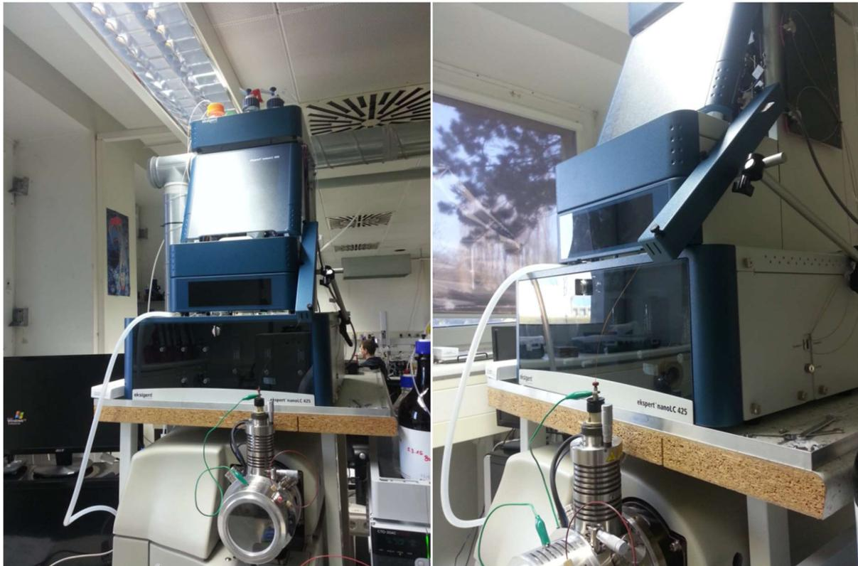
Abbildung 30: Kopplung des miniaturisierten 2D-LC-Systems (Expert NanoLC 425) mit QTrap 3200 im Labor der Forschungseinrichtung 1.
