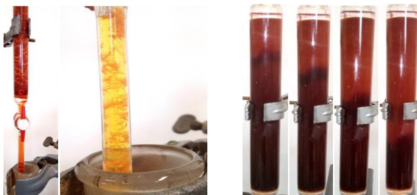
Abbildung 37 Links: Kristallisation während der Extraktion des Palladiums durch die stationäre Phase, rechts: Extraktion des Palladiums mit 0,1 M HCl/Thioharnstofflösung.
