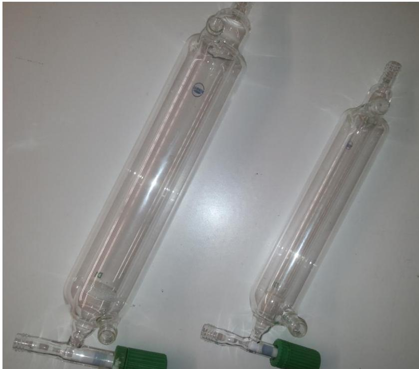
Abbildung 32 Glasreaktor mit Doppelwand zur Temperierung als Reaktor.
