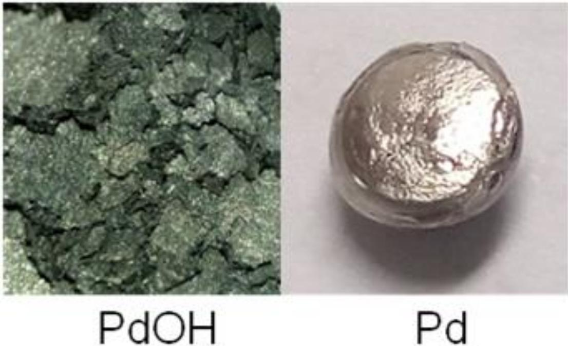
Abbildung 38 Links: Palladiumhydroxid gefällt aus Palladium-Thioharnstofflösung, rechts: Palladiumnugget (Durchmesser etwa 8 mm) geschmolzen aus Palladiumhydroxid.
