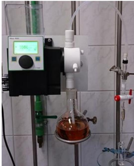
Abbildung 30 Membrandosierpumpe Ritmo 033 der Firma Fink Chem + Tec GmbH & Co.KG gekoppelt an Kleinstsäule aus Vorversuchen.
