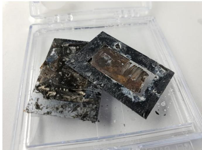
*Abbildung 16: Si-MEMS-Membranen mit Nafionbeschichtung und oberflächlich eingelagerten Platinpartikeln nach dem Versuch eines Partikelwachstums.*
