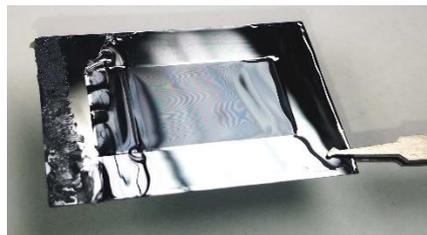
Abbildung 14: Foto einer mit Nafion D2020 mittels Tauchbeschichtung beschichteten Si-Membran.
