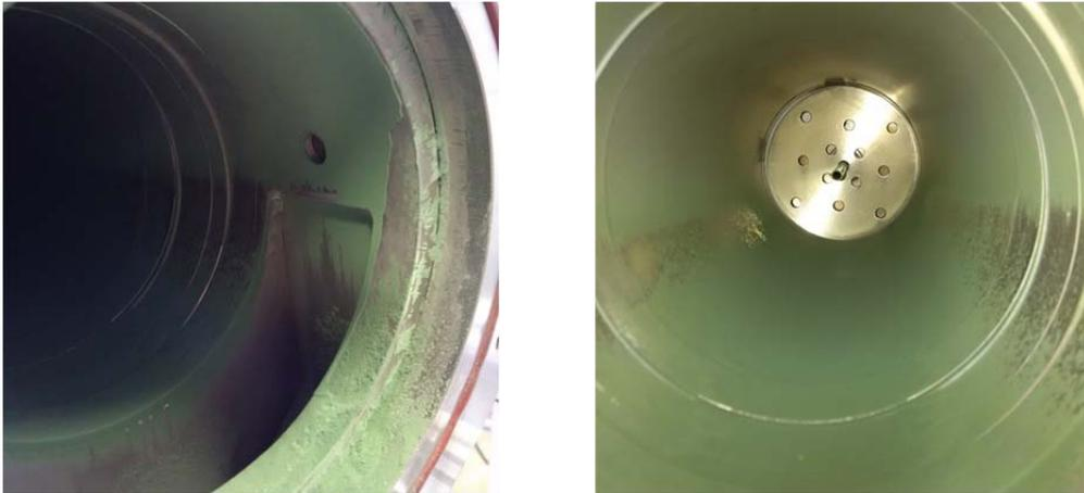
Abbildung 34: Verteilung des Cu-Katalysators auf der Kanalinnenwand
