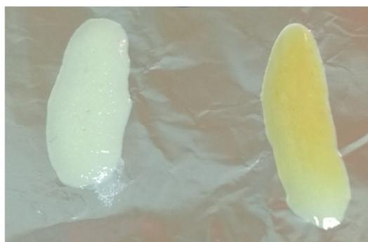
Abbildung 111: Mischung mit 10 phr TPO. Links: ohne Bestrahlung und anschließender Vulkanisation, Rechts: nach 5 Minuten Bestrahlung und anschließender Vulkanisation
