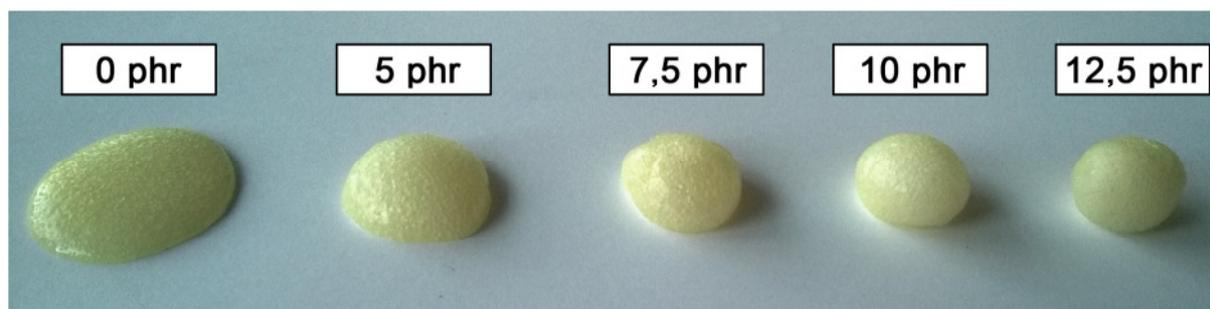
Abbildung 97: Mischungen mit unterschiedlichen Aerosil-Anteilen und 20 phr LBR, nach der Vulkanisation bei 180 °C
