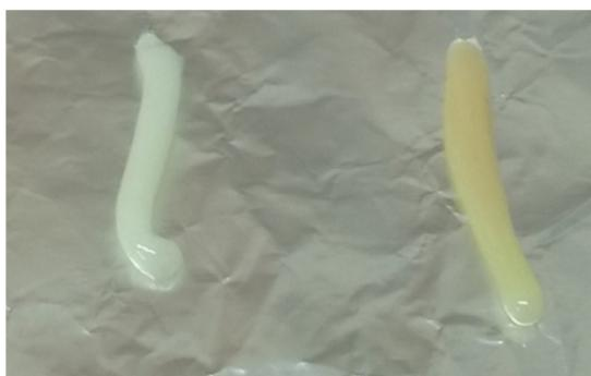
Abbildung 110: Mischung mit 10 phr TPO. Links: ohne Bestrahlung, Rechts: nach 5 Minuten Bestrahlung
