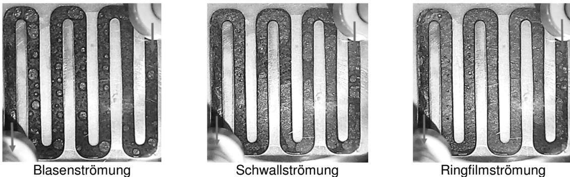
Abbildung 9: Strömungsformen auf der Anode
