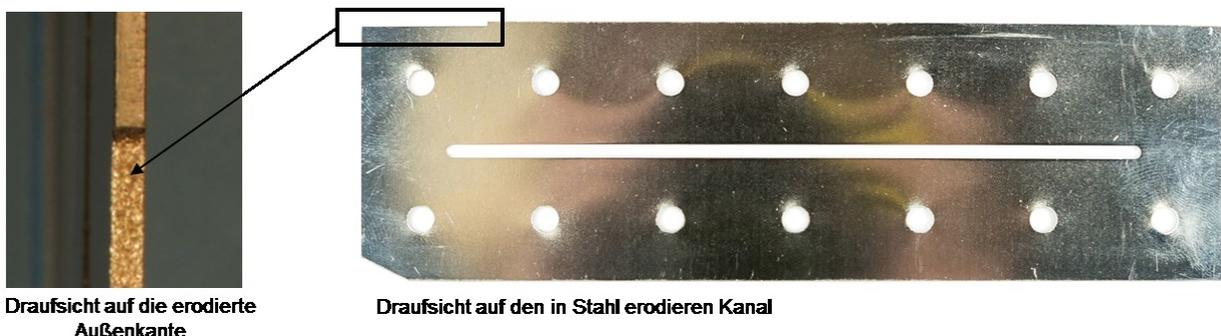
Abbildung 16: Draufsicht auf die in Stahl erodierte Kanalstruktur und Zoom-Ansicht der an der Außenkante erodierten Vergleichsfläche.
