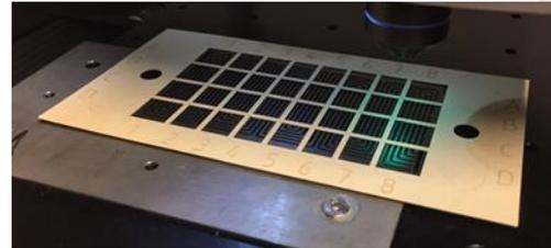
Abbildung 4: MEA mit Acrylglasumrandung und Raster zur Ausgangsanalyse und späteren Gegenüberstellung geschädigter MEAs
