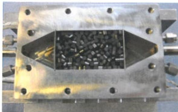
Abb. 2: Plug-Flow-Reaktor
