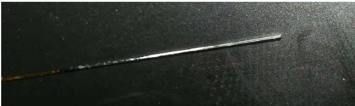
Abbildung 2-21: Foto einer verstopften Fused-Silica Kapillare (75  $\mu\text{m}$  ID).
