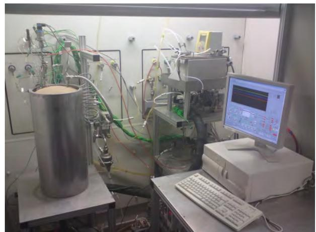
**Abbildung 9:** Brenner/Vorwärmer-Einheit vor dem Zusammenbau (o. links); Brenner /Vorwärmer-Einheit montiert im Gasprozess außerhalb der Isolationshülle (o. rechts); Reformersystem in der Isolationshülle (u. links); Reformersystem mit Teststandsperipherie (u. rechts)
