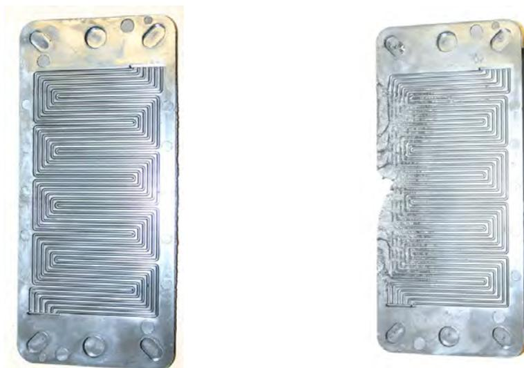
**Abb. 11: HT-BPHP, links Polymer 2, rechts Polymer 3, Füllgrad 70%**
