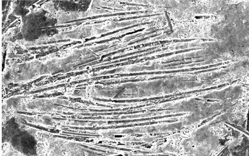
**Abb. 60: GDL Abdruck an der Oberfläche nach Ofentest**
