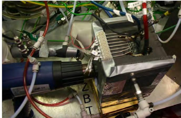
**Abb. 63: 7-Zeller Stack mit elektrischer Luftbeheizung und Einzelspannungsüberwachung**
