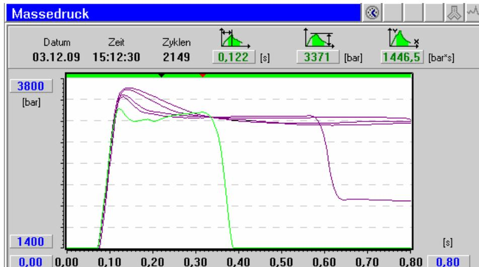
Abb. 12: Druckverlaufskurve von 2 verschiedenen Füllgradientischen HT-Compounds
