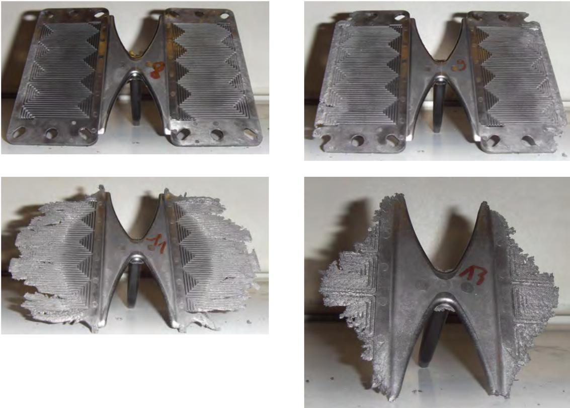
Abb. 35: Füllstudie mit Niedertemperatur Compound
