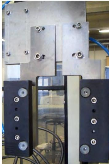
**Abb. 46: Kopf der robotischen Entnahme, ausgelegt für HT-Anwendungen**
