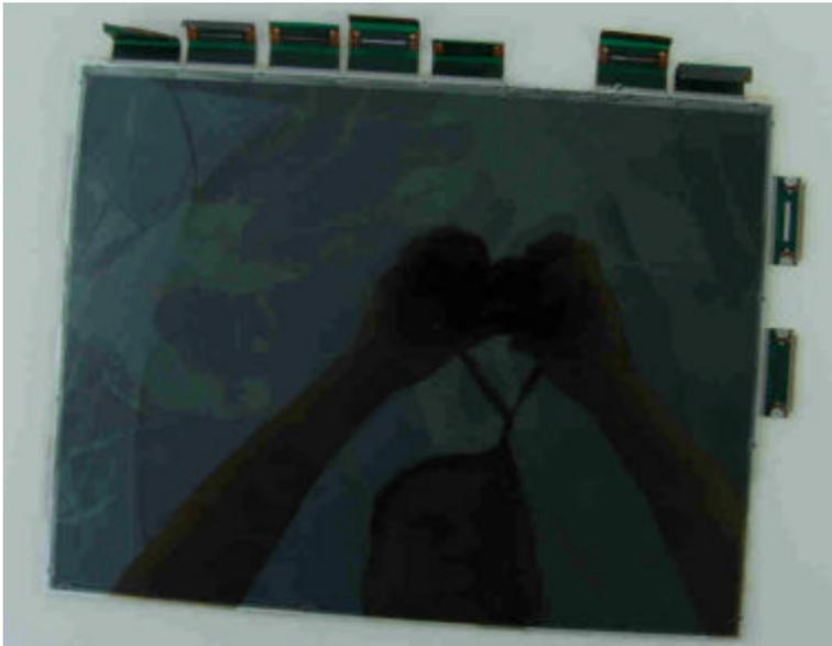
**Abbildung 24: TFT – Display demontiert**
