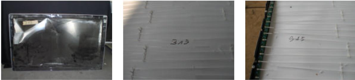
**Abbildung 3: Transportschäden an LCD Geräten**
