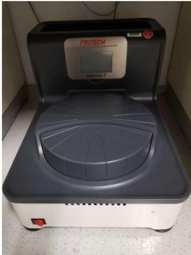
**Abbildung 63:** Planeten-Mikromühle Pulverisette 7 premium line der Firma Fritsch
