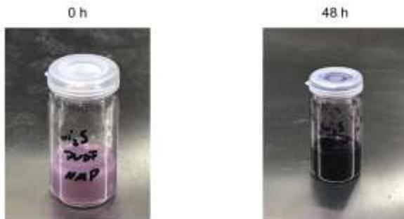
**Abbildung 8:** Gezeigt ist eine Dispersion von  $\text{Li}_2\text{S}$  in einer NMP/PVDF-Lösung. Das Bild links zeigt die Dispersion nach Zugabe des  $\text{Li}_2\text{S}$ , das Bild rechts nach 48 h unter stetigem Rühren.
