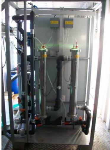
**Abbildung 4: Aufbau der Durchflussanlage.**
