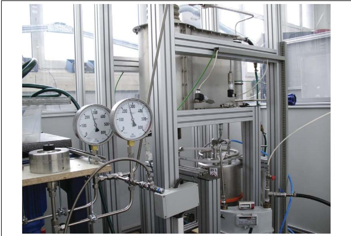
**Abbildung 5.5** Fertig montierte SCWR-Anlage im Betrieb
