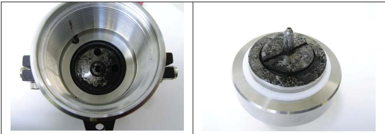
**Abbildung 3.3** Rußablagerungen im Vordruckregler nach einem Reformierungsversuch (SCWR-Laboranlage)
