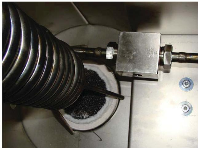
**Abbildung 40:** Blick in den Brennraum ohne Dämmung, Brennerkopf unterhalb der Rohrwendel
