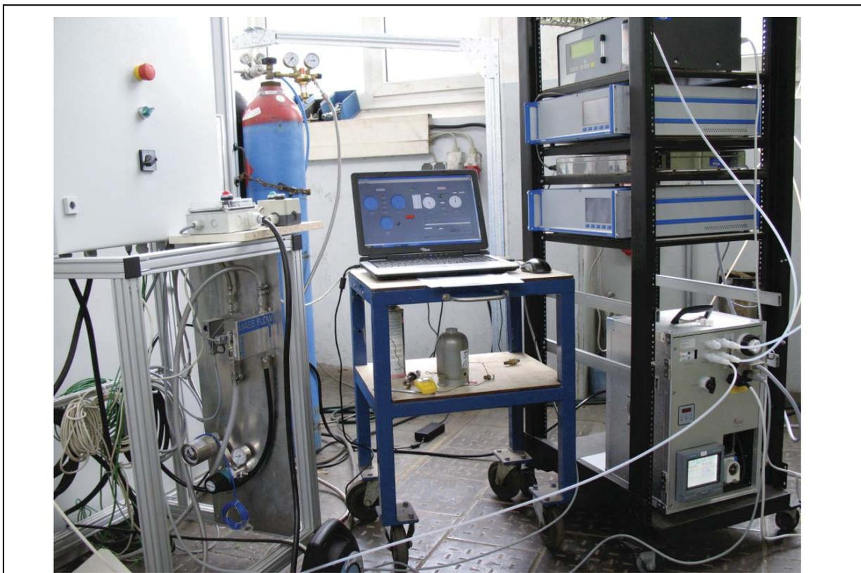
**Abbildung 5.7** Gasversorgung des Brenners, Messgeräte zur Gasanalyse und Schaltschrank Prozessüberwachung
