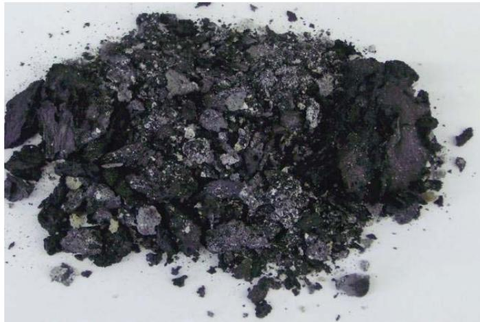
**Abbildung 10: Rückstand des Veraschungsversuches eines handelsüblichen Rohglyzerins**
