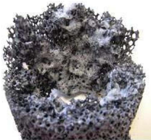
**Abbildung 7: Vergrößerter Ausschnitt einer zerstörten Schaumkeramik [GWA08]**
