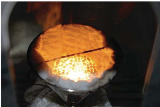
**Abbildung 18: Verbrennung von pharmazeutischem Glycerin in einem Trichterbrenner mit inerter Schüttung aus Al<sub>2</sub>O<sub>3</sub>**
