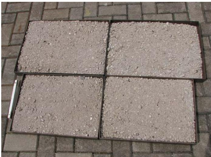
Bild 21 Trockenschalen mit RC-Material
