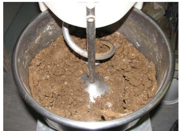
Bild 35 a/b Einmischen von 0,5 Masse-% Flachsschäben in Aushubboden - Gemisch Flachsschäben-Aushubboden nach 9 min
