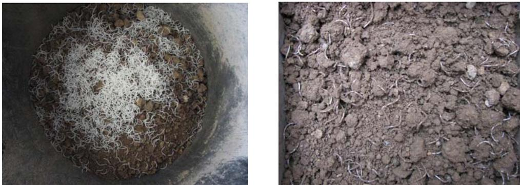
Bild 39 a/b PLA Nr. 6 vor der Einmischung in den Aushubboden - Detail des PLA-Bodengemisches im Scherkasten
