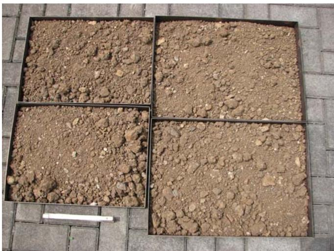
Bild 26 Trockenschalen mit Aushubboden
