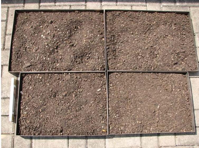
Bild 24 Trockenschalen mit Mutterboden
