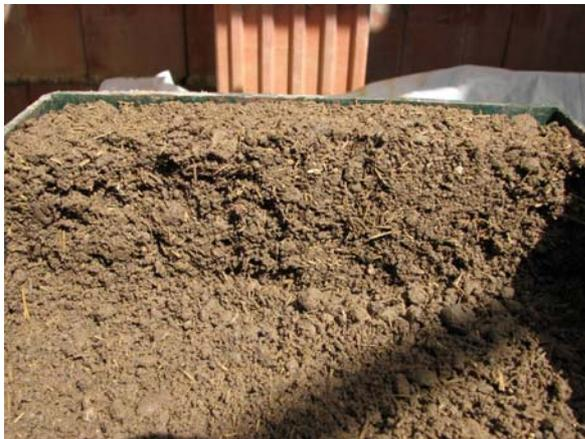
Bild 36 Schnitt Bambus-Recyclingmaterial im Scherkasten
