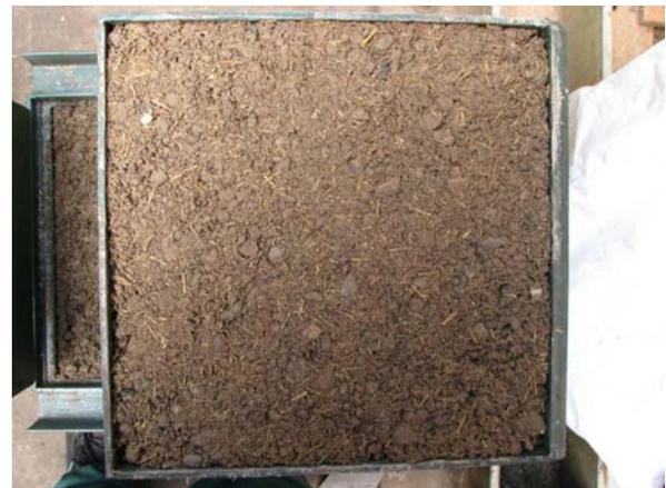
Bild 37 Gemisch Bambus-Recyclingmaterial im Scherkasten
