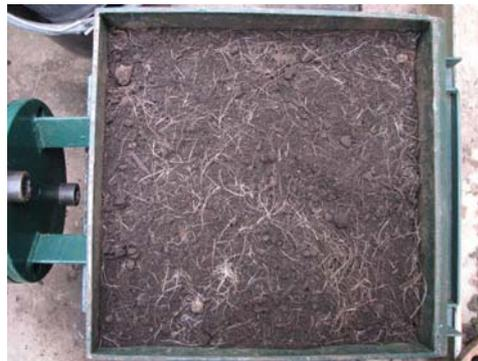
Bild 38 a/b Proctortopf mit verdichtetem Mutterboden und Sisal - Gemisch Mutterboden-Sisalfasern im Scherkasten
