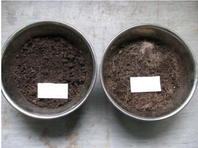
Bild 33 Einmischung von 0,5 % (links) und 1,5 % Sisalfasern in den Mutterboden (rechts mit Nesterbildung der Sisalfasern)
