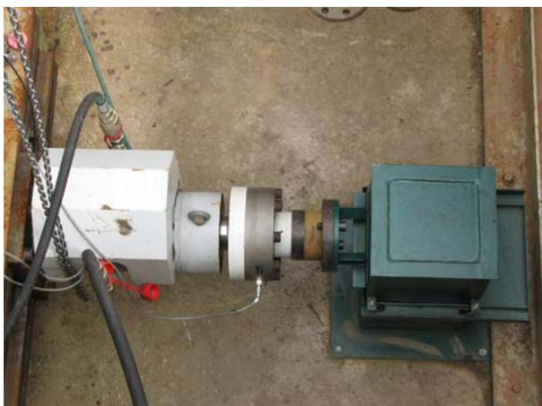
Bild 34 Versuchsaufbau Presse - Scherkasten
