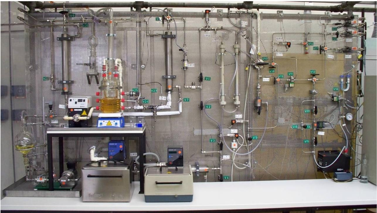
**Abbildung 19:** Versuchsanlage mit zwei Membrankontaktorabsorbern
