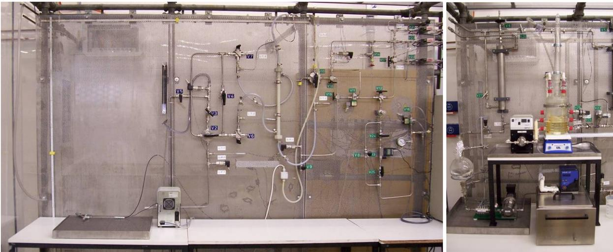
**Abbildung 17:** Versuchsanlage vor Umbau (links) und mit Regenerationseinheit (rechts)
