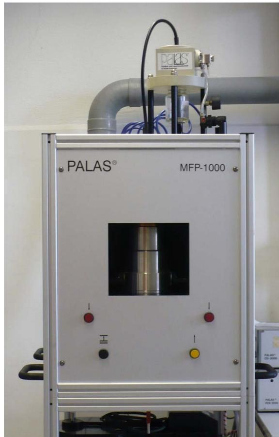
**Abb. 3.38 Filtermedienprüfstand MFP 1000 mit Aerosolgenerator AGF 2.0**
