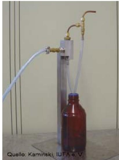
Abb. 3.17 Aerosolgenerator zum Vernebeln von Flüssigkeiten oder Salzlösungen
