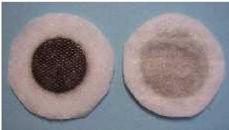
Abbildung 26 Filter nach ca. 5-stündigem Betrieb am Kanaleingang (links) und am Kanalausgang (rechts)
