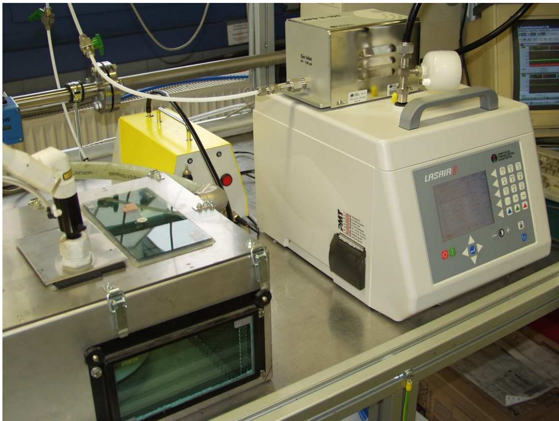
Abbildung 43 Versuchsanordnung Testaerosolmessung mit Aerosolgenerator ATM 225
