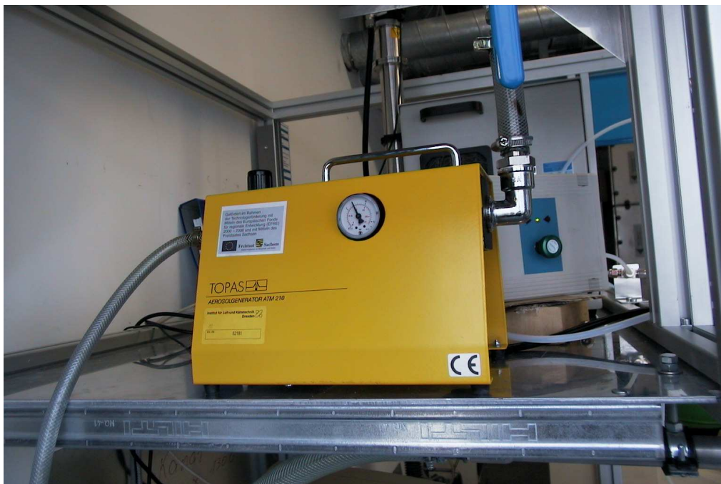
Abbildung 35 Versuchsanordnung Testaerosolmessung mit Aerosolgenerator ATM 210
