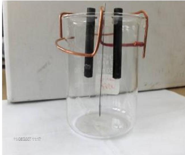
Mit diesem einfachen Aufbau wäre es prinzipiell auch möglich, neben der Produktion geringer Mengen elektrischer Energie das hochtoxische  $\text{Cr}^{\text{VI}}$  auf einfachem Wege zu  $\text{Cr}^{\text{III}}$  zu reduzieren, was zur Senkung der bisherigen hohen Entsorgungskosten dieser Lösungen führen kann.
