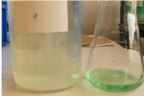
Die Entfärbung der grünen Lösung spricht für eine Rückreduktion zu farblosen  $Cu^+$ -Ionen. Diese Reaktion deutet klar auf das Vorhandensein des Zinns in Form von Zinn(II)-Ionen, die als starke Reduktionsmittel die beobachtete Rückreaktion bewirken.
