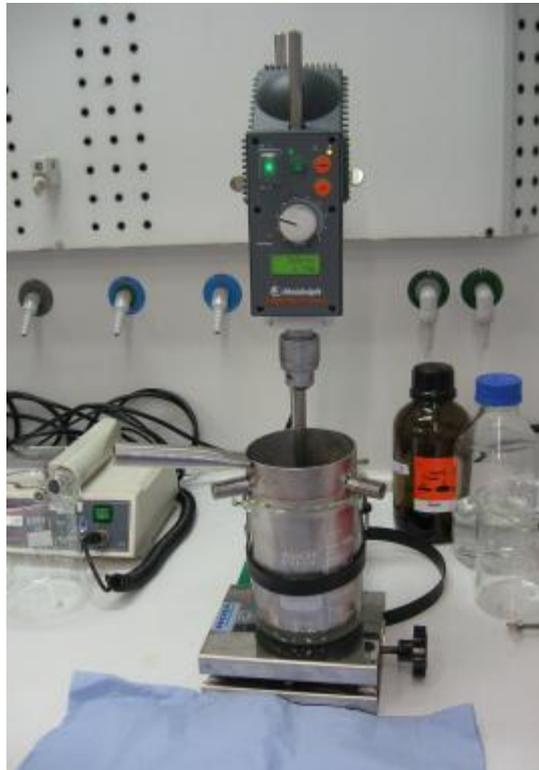
Ähnlich wie das in [46] dargestellte kegelförmige Präzipitationsaggregat, arbeitet auch der hier als Demonstrator konstruierte Sieb-Rühr-Reaktor. Im Inneren des Reaktors läuft einerseits der Zementationsprozess ab und andererseits wird Zementat durch den Siebboden ausgetragen (Bild 20 und Bild 21). Auf diese Weise werden auf dem Aluminium immer wieder frische, mit Keimen zum weiteren Wachstum belegte Flächen geschaffen, die nicht von anhaftendem Zementat blockiert werden.
