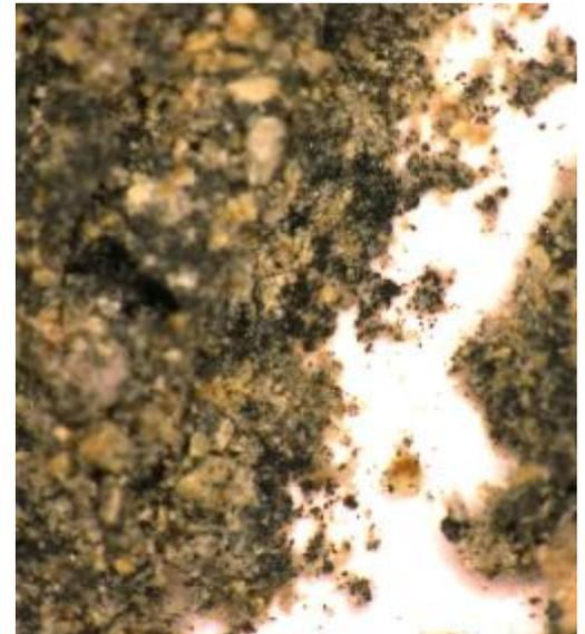
Das Zementat lässt sich durch Spülen, Sieben und Filtrieren gut von den PE-Resten separieren.
