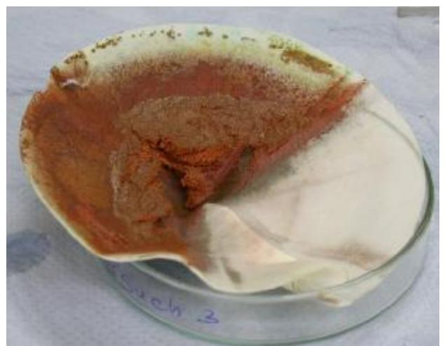
Unter Berücksichtigung der Erkenntnisse aus den Referenzversuchen wurden Versuche mit Rejectmaterial verschiedener Fraktionen in synthetischer Altbeizsäure (unterschiedliche pH-Werte) und Zugabe von Salzsäure (variierende Mengen) begonnen, um Ausbeuten, Qualitäten und Reaktionsverhalten zu untersuchen. In Bild 28 bis Bild 31 ist ein typischer Reaktionsverlauf von Rejectmaterial der Fraktion < 10 mm in synthetischer Altbeizsäure und Zugabe von Salzsäure dargestellt.
