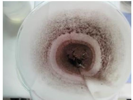
Bei der Betrachtung des stückigen Siebrückstands mit dem Digitalmikroskop (Keyence vhx) sind nur noch vereinzelt Aluminium-Reste sichtbar. Nur in Bereichen, die weiter von einer Schnittkante, d. h. möglichen Angriffsstelle der Chlorid-Ionen, entfernt sind, ist Aluminium verblieben. Die Verästelungen reichen tief ins Innere der einzelnen Stücke hinein (Bild 62 und Bild 63).
