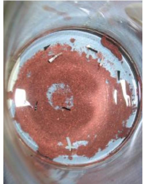
Der Zementationsfortschritt, d. h. der Abbau der Aluminiumschicht, und die somit freigelegten Randbereiche sind in Bild 56 deutlich festzustellen.
