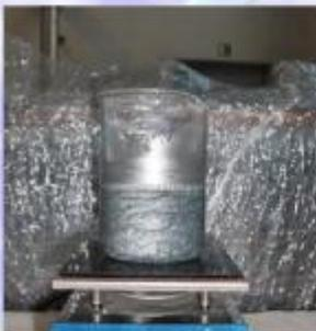
Bild 1: Cu-haltige Schwefelsäure mit Al-Pulver versetzt
