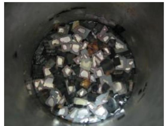
Bei Versuchsende hatte sich am Boden des Becherglases Zementat (Bild 54) abgesetzt, welche z. T. nadelförmige, aber auch dendritische Struktur aufweist (Bild 55).
