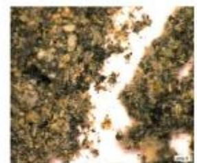
Filterrückstand (links) und Glührückstand mit Cu-Gehalt von 70 %
