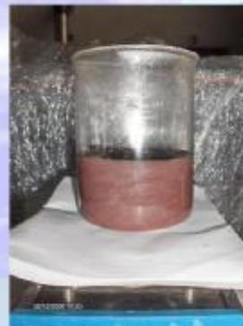
Bild 3: Nach Stehen über Nacht und kurz vorher erfolgter  $\text{Cl}^-$ -Zugabe
