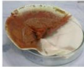
Filterrückstand nach Zementation
