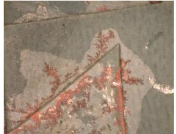
Wie Zementat an den Angriffsflächen aufwächst, ist in Bild 64 und in Bild 65 gut zu sehen.
