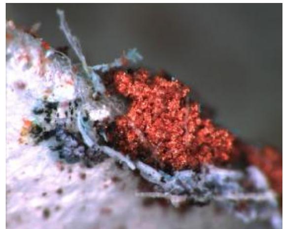
Deutlich sichtbar sind in Bild 33 und Bild 34 die wenigen Aluminiumrestbestandteile und die rot eingefärbten Randbereiche sowie an aufgebrochener PE-Schicht gebildetes Kupfer (Bild 35).
