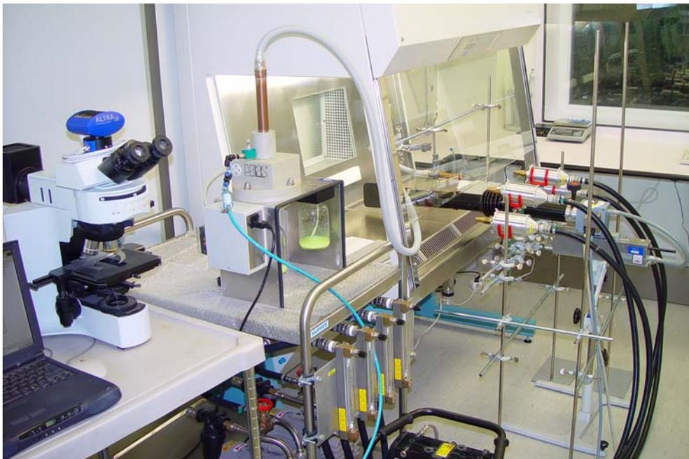
**Abbildung 24:** Vollständiger Prüfaufbau in Modell-Offizin-Apotheke.
