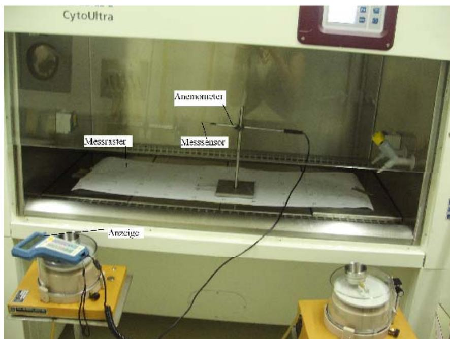
Abb.A.6.2.1.: Messung der Verdrängungsströmung
