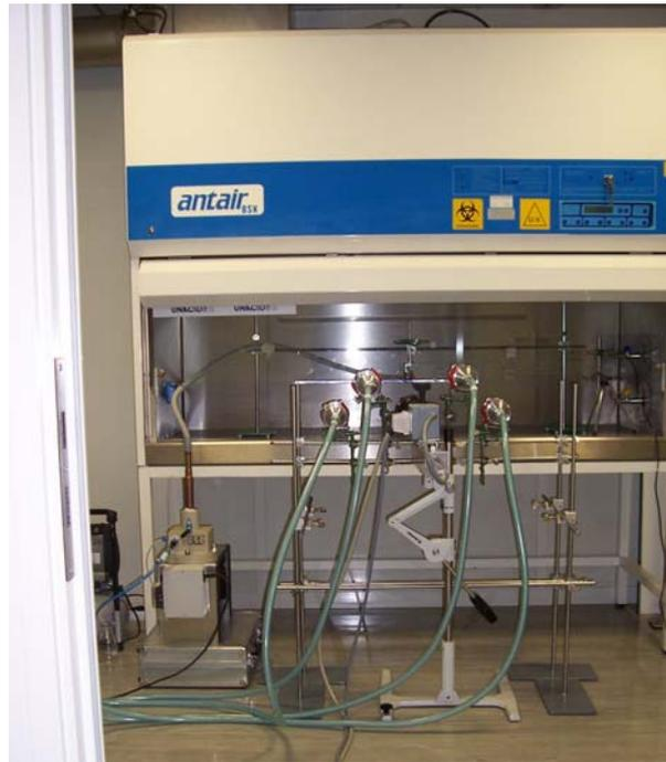
**Abbildung 44:** Prüfaufbau mit links angeordnetem Aerosolgenerator, Prüfarm und Impaktoren.
