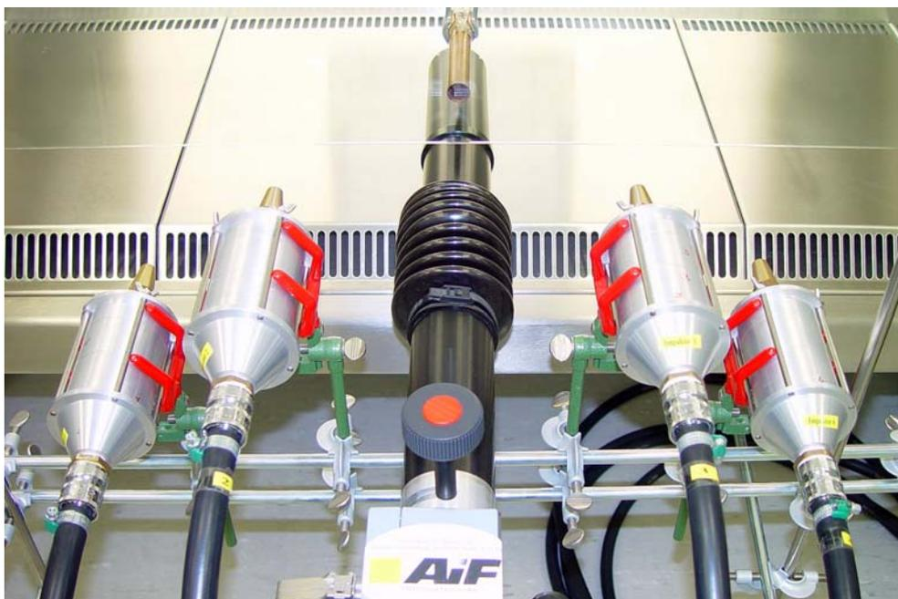
**Abbildung 23:** Teil des Prüfequipments bestehend aus beweglichem Prüfarm und 4 Probenehmern (Impaktoren) auf Stativen sowie Aufgabesonde für das Prüfaerosol.
