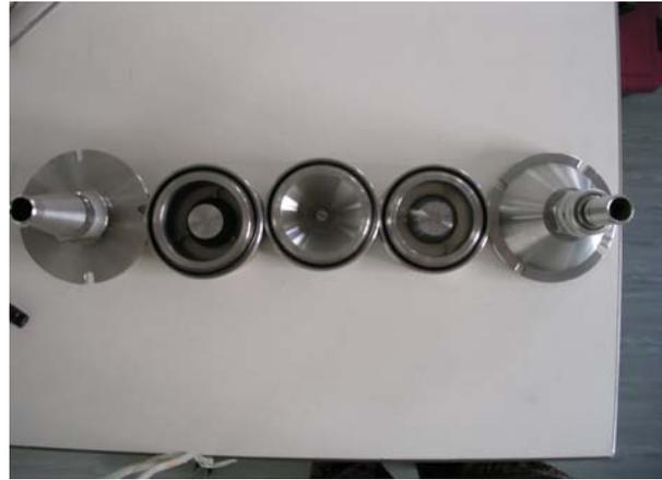
**Abbildung 37 und 38:** *Impaktor als Probenehmer mit Prall- und Schlitzdüsenabscheidestufe.*
