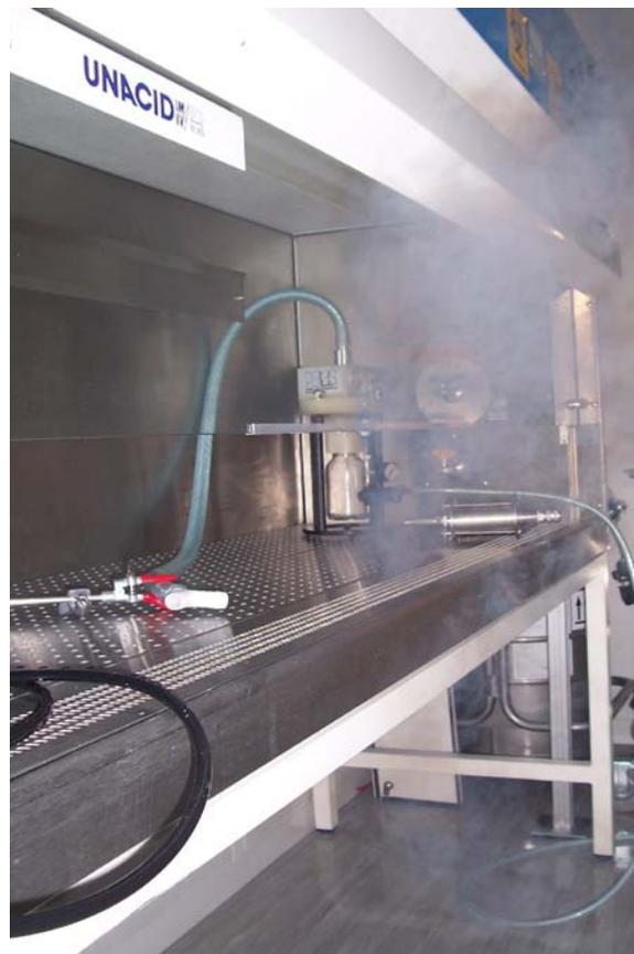
**Abbildung 36:** Strömungsvisualisierung bei Betrieb der SWBK und der FFU in der Reinraumkabine.
