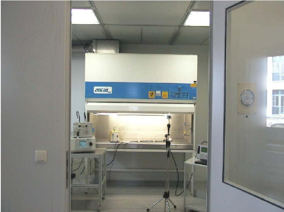
**Abbildung 35:** Sicherheitswerkbank Antair VBH 72 (Klasse II) aufgestellt in der Reinraumkabine des ILK.
