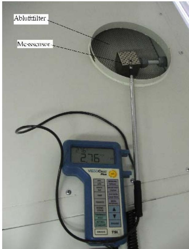
Abb. A.6.1.2.: Messung der Luftereintrittströmung an der Sicherheitswerkbank für Zytostatika von Telstar mit dem Anemometer von TSI
