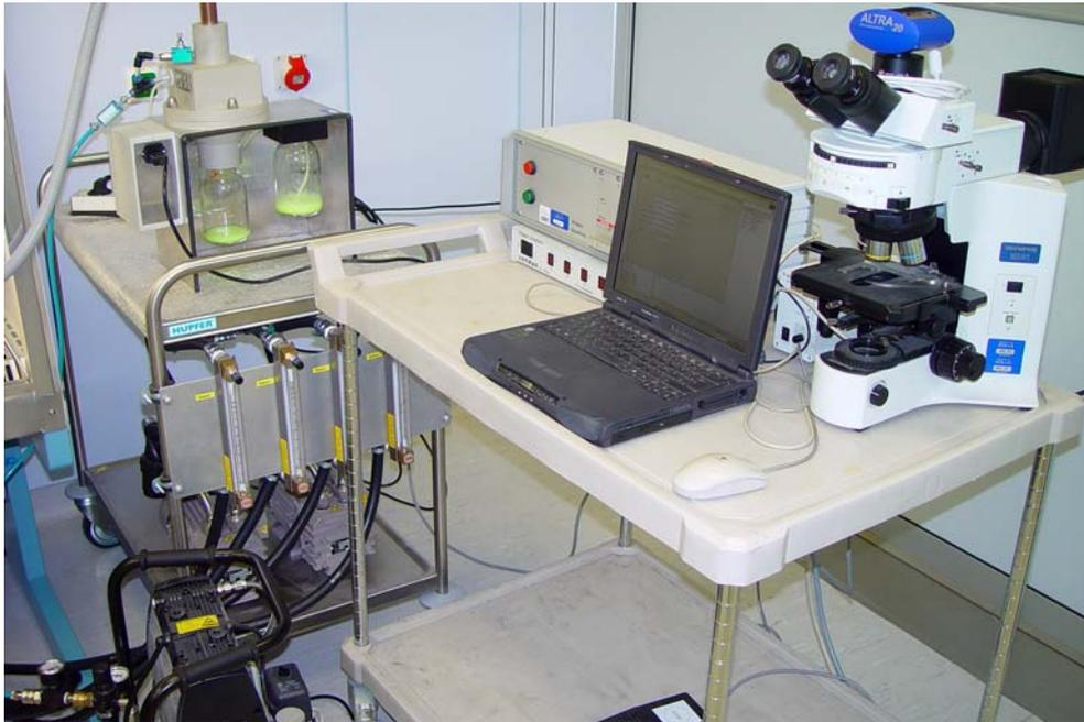
**Abbildung 22:** Teil des Prüfequipments bestehend aus Aerosolgenerator mit Kompressor, 4 Rotametern, 2 ölfreie Drehschieberpumpen, Steuer- und Schalteinheit für Prüfarm, Laptop, Fluoreszenz-Mikroskop mit CCD-Kamera sowie 2 Laborwagen.
