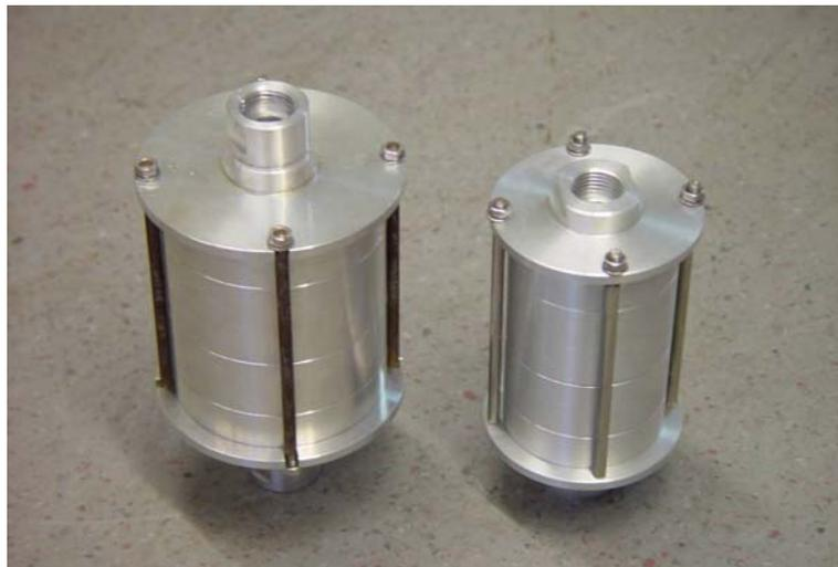
**Abbildung 1:** Zweistufen-Eindüsen-Schlitzimpaktoren – Probenehmer aus dem Vorläufervorhaben (links) sowie der kleinere und leichtere aus dem aktuellen Forschungsvorhaben (rechts).
