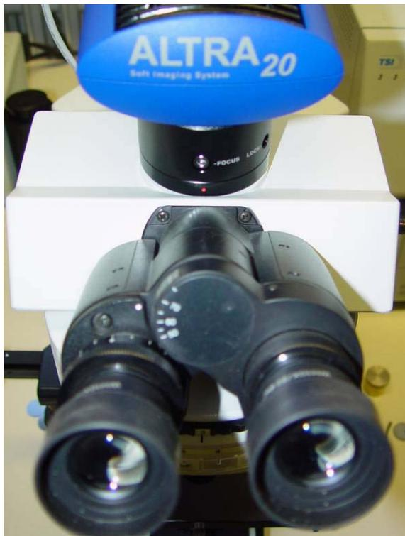
**Abbildung 18a:** Fluoreszenz-Mikroskop mit CCD-Kamera.
