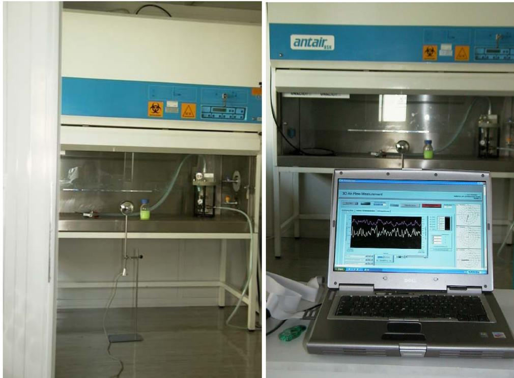
**Abbildung 32:** Strömungssensor TSD vor der Arbeitsöffnung der Sicherheitswerkbank.
