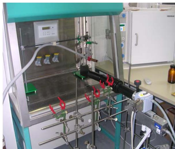
**Abbildung 47:** Prüfarm an der rechten und linken Seite der Sicherheitswerkbank der Klasse II Hera Safe Modell KSP 9
