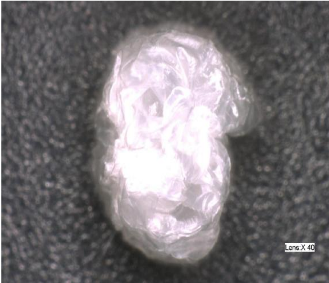
Abbildung 26: V 934-7, Hexagonale Zellstruktur, hohe Zelldichte
