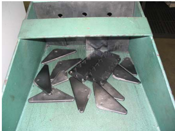
Abb. 29: Wiederverwertung von Bipolarplatten-Angüssen und bereits in PEM-Stacks eingesetzten thermoplastischen Bipolarplatten: Schneidmühle; Tonne mit Angüssen; Einzug der Schneidmühle mit Angüssen und Bipolarplatten; Tonne mit Produktgranulat (Universität Duisburg-Essen / ZBT).
