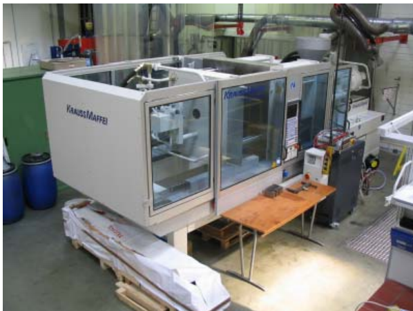
Abb. 30: Spritzguss von thermoplastischen Bipolarplatten: Doppelschneckenextruder, Compoundgranulat, Spritzgussmaschine, spritzgegossene Bipolarplatten (Universität Duisburg-Essen / ZBT).
