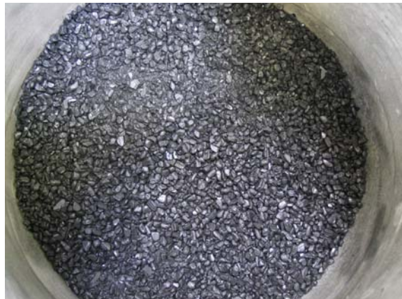
Abb. 29: Wiederverwertung von Bipolarplatten-Angüssen und bereits in PEM-Stacks eingesetzten thermoplastischen Bipolarplatten: Schneidmühle; Tonne mit Angüssen; Einzug der Schneidmühle mit Angüssen und Bipolarplatten; Tonne mit Produktgranulat (Universität Duisburg-Essen / ZBT).
