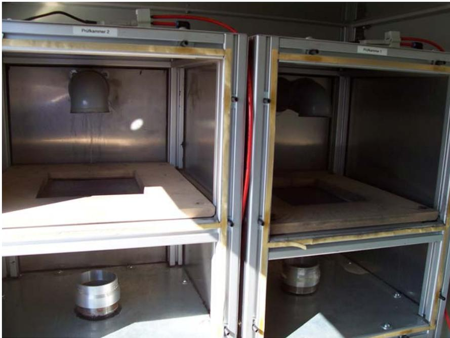
**Abb. III-6:** Prüfkammern des Filterprüfstandes mit eingebauten Innenraumfiltern
