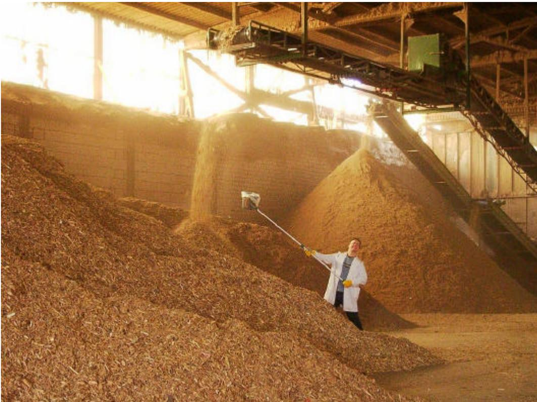
**Abbildung C.3:** Probenahme nach LAGA PN 98 aus frei fallendem Produktstrom
