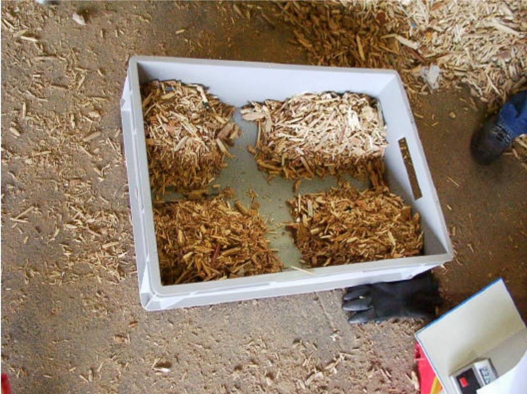
**Abbildung C.15:** Vierteln der Mischprobe nach LAGA PN 98
