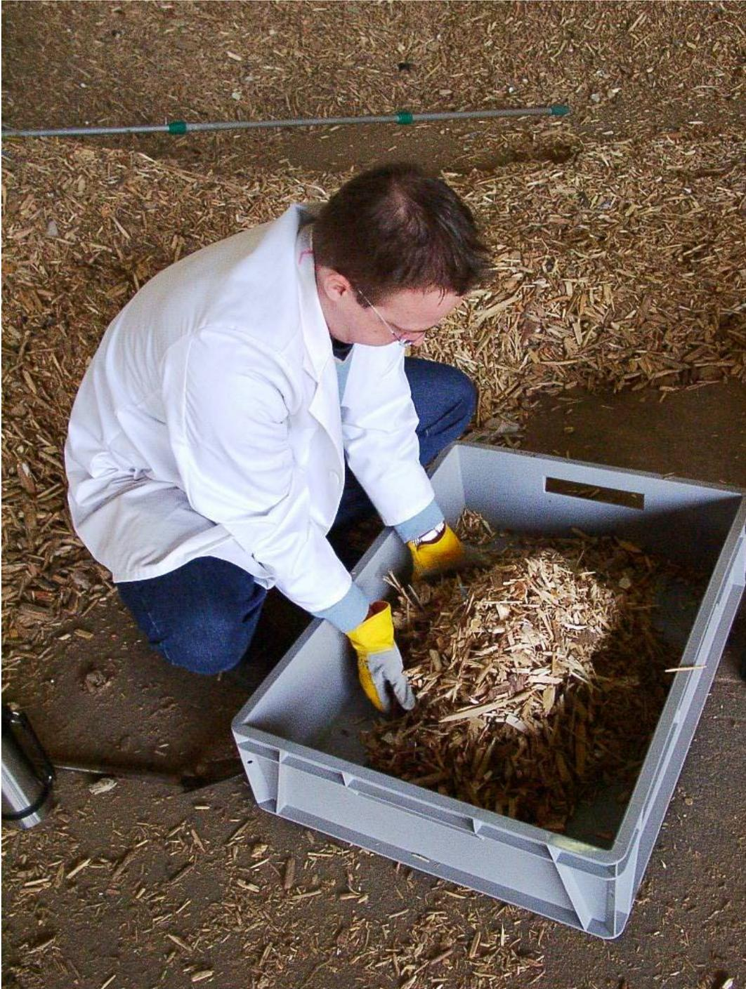
**Abbildung C.4:** Herstellung einer Mischprobe aus 4 Einzelproben nach LAGA PN 98
