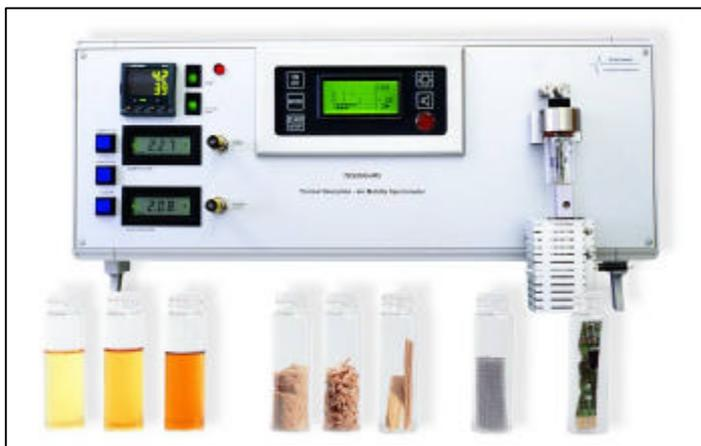
**Abbildung 4.2.1:** Thermodesorptions(TDS)-IMS-Kopplung (TDS2000-IMS)
