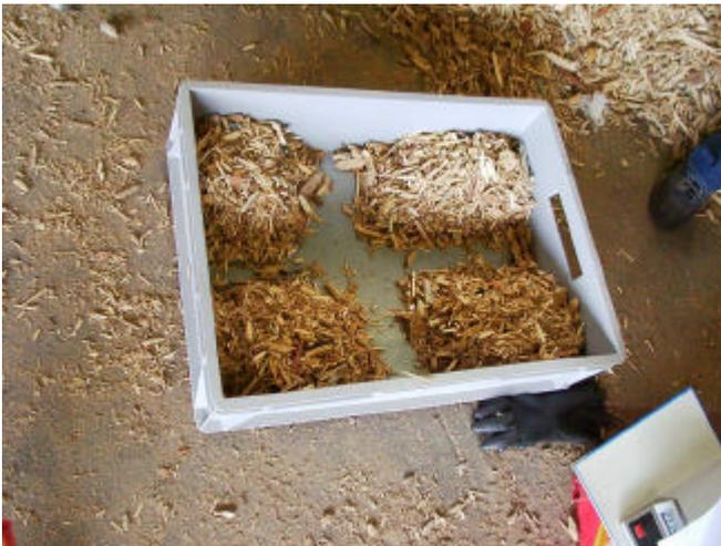
**Abbildung 5.5:** Vierteln der Mischprobe nach LAGA PN 98
