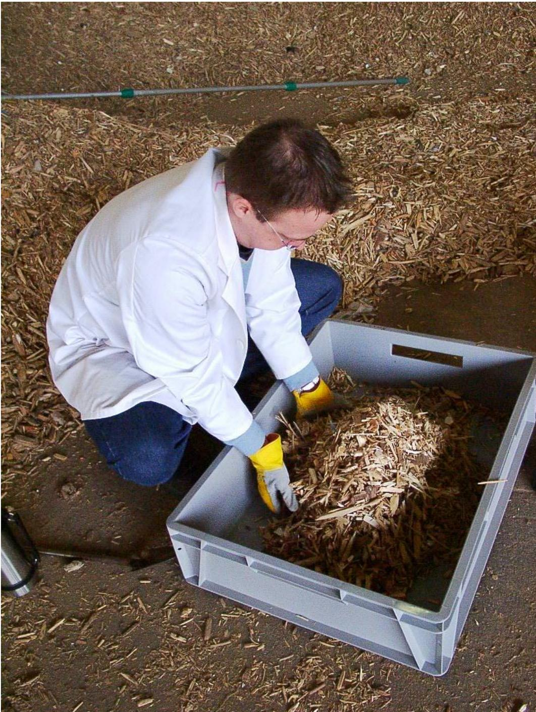
**Abbildung C.14:** Herstellung einer Mischprobe aus 4 Einzelproben nach LAGA PN 98
