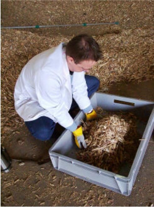
**Abbildung 5.4:** Herstellung einer Mischprobe aus 4 Einzelproben nach LAGA PN 98
