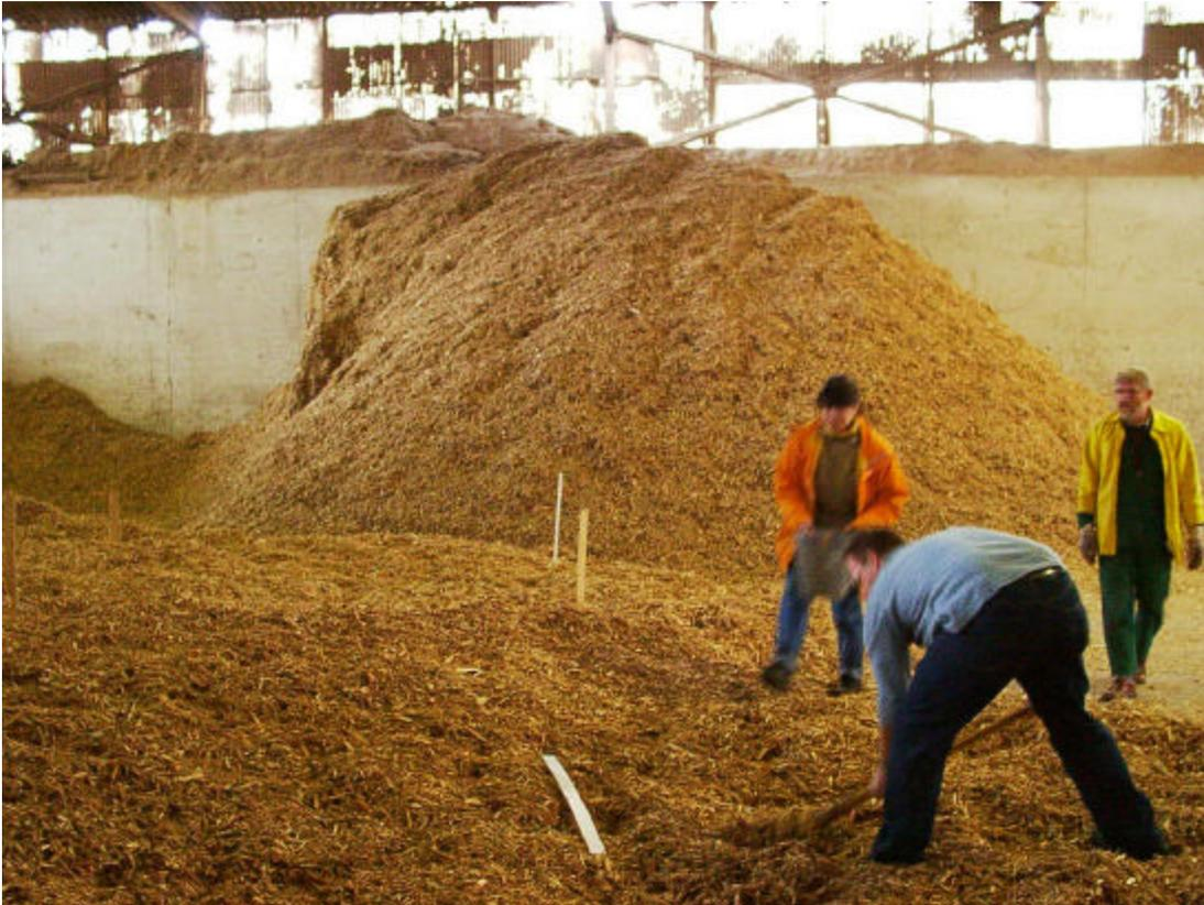
**Abbildung C.23:** Probennahme aus dem ausgebreiteten Teilhaufwerk mit dem Spaten in verschiedenen Tiefen
