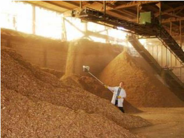
**Abbildung 5.2:** Probenahme aus fallendem Produktstrom
