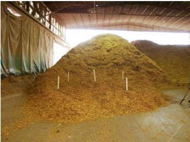
**Abbildung 5.3:** Markierung der Probenahmepunkte Haufwerksbeprobung
