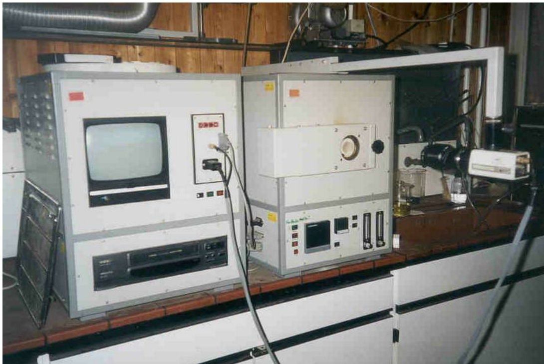
Abbildung 15 Asche-Schmelzmikroskop an der TU Stuttgart
