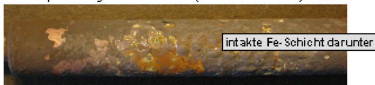
Probe 1 (Kopfmitt) mit Belagschicht ohne Staub (Oxidschicht sichtbar)
