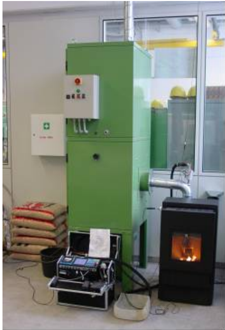
Abbildung 9: Korrosions-Vorversuche mit Rauchgasanalytik
