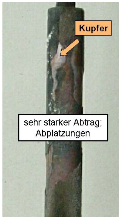
Abbildung 18: Holz mit 5g Cl / kg bei 820°C Rauchgas- und 500°C Heatpipe-Temperatur
