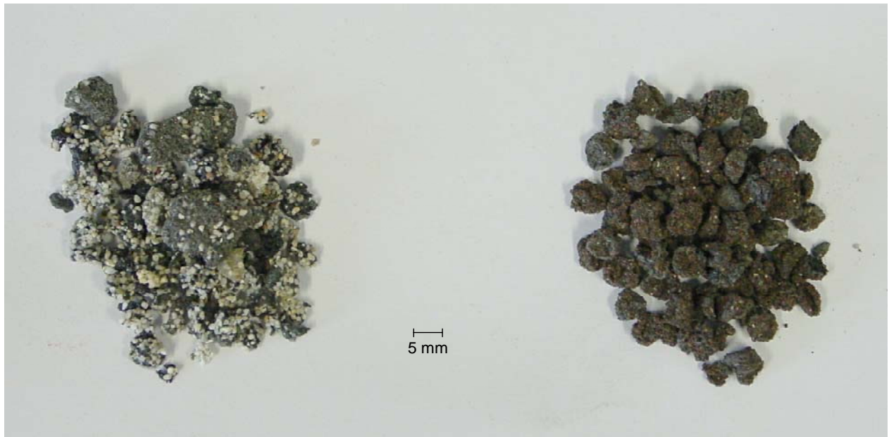
Abbildung 30: Ausgesiebte Agglomerate (> 1,5 mm) aus der Wirbelschicht mit Quarz (links) und Olivin (rechts) als Bettmaterial. Versuche bei 850°C.
