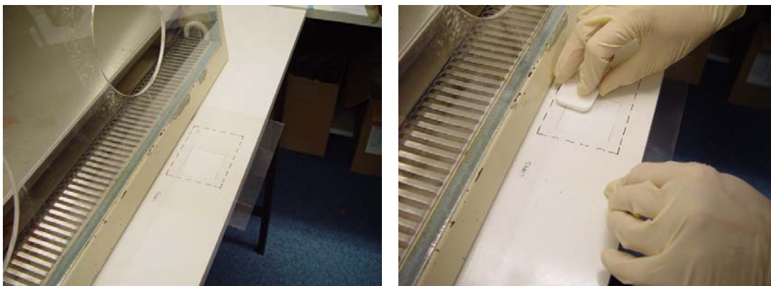
Abbildung 50 Bilder zur Vorgehensweise bei der vor Ort Anwendung des MTX-Wischttests. Linkes Bild: Die Probenahmestelle wird mit einer ausgeschnittenen Folie abgegrenzt. Rechtes Bild: Nach der Befeuchtung der Fläche wird diese mit dem Wischttests beprobt.
