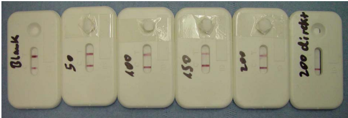
Abbildung 49 Darstellung der Wischtestergebnisse im Konzentrationsbereich von 50 ng bis 200 ng MTX pro 25 cm 2 Flächenkontamination. Links ist ein Blindwert und rechts ein Test nach direkter Aufgabe von 200 ng MTX dargestellt.
