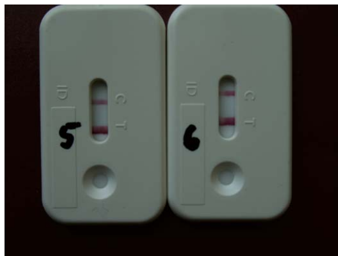
Abbildung 43 Darstellung von Testlinien mit zu hoher MTX-BSA-Konzentration in der Testlinie und zu niedriger Viskosität der als Testlinie aufgesprühten Lösung. Die Testlinie (T) ist wesentlich breiter verlaufen und intensiver
