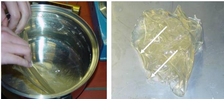
Abb. 4.4.1: links: Abziehen des Gelatinefilms aus einem zylindrischen Edelstahlgefäß; rechts: entfernter elastischer Film, abgelöst einige Minuten nach dem Auftragen
