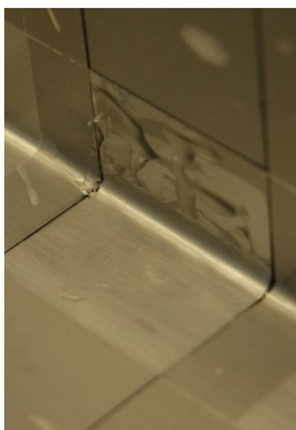
Abb. 4.7.3c: Rückstände von geliertes 1,5%iger Agarlösung an der senkrechtstehenden Fläche eines gewinkelten Edelstahlblech nach dem Ablösevorgang
