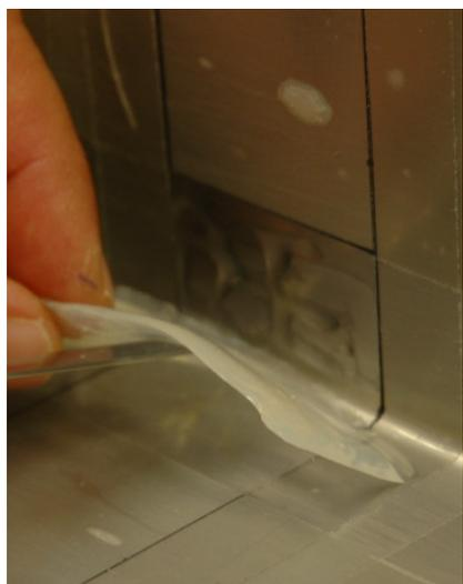
Abb. 4.7.3b: Ablösen von geliertes 1,5%iger Agarlösung von einem gewinkelten Edelstahlblech
