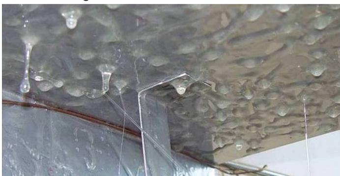
Abb. 4.4.4: Tropfenbildung nach Aufsprühen auf überhängenden Flächen, Airless-Handsprühsystem (Betriebsdruck: 3 bar, Betriebstemperatur: ca. 40 °C, Hohlkegeldüse 1,0 mm, 20%ige Gelatinelösung)
