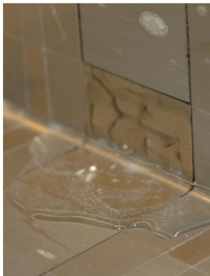
Abb. 4.7.3a: 1,5%ige Agarlösung direkt nach Aufbringen auf ein gewinkeltes Edelstahlblech
