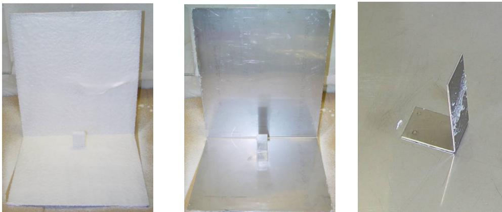
Abb. 4.4.11: Winkelblech, beschichtet und abgereinigt (links, Mitte); Restanhaftungen am hinter-schnittenen Flächenelement (rechts)
