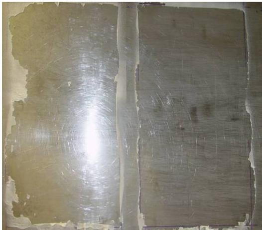
Abb. 4.4.21: Sprühversuch, Flächen nach Sprühreinigung mittels Gelatine mit (links) und ohne (rechts) Weichmacherzusatz
