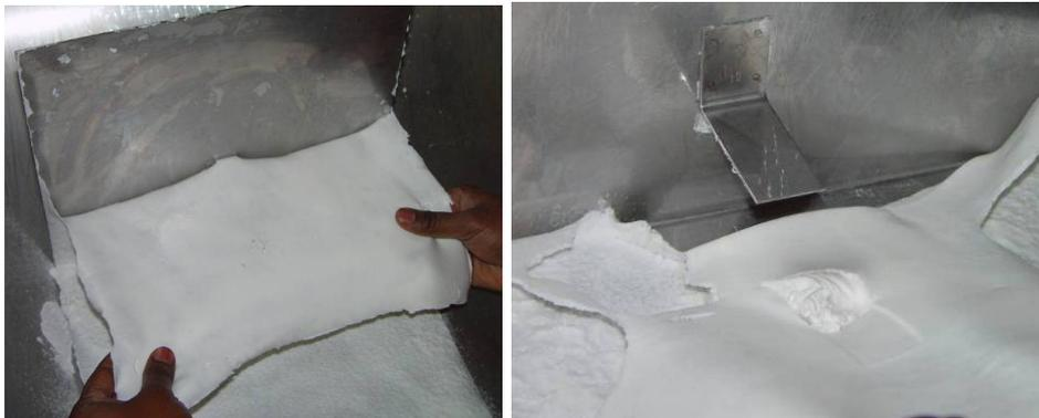
Abb. 4.4.10: Entfernen des aufgesprühten, elastischen Gelatinefilms vom Winkelblech
