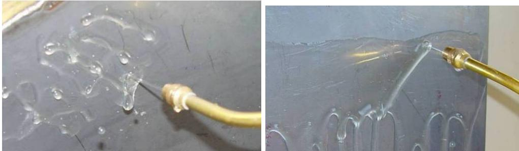
Abb. 4.4.3: Gelatine-Applikation, Airless-Handsprühgerät (links: Betriebsdruck: 3 bar, Betriebstemperatur: ca. 40 °C, Hohlkegeldüse 1,0 mm, 20%ige Gelatinelösung; rechts: Betriebsdruck: 6 bar, Betriebstemperatur: ca. 40 °C, Hohlkegeldüse 1,0 mm, 20%ige Gelatinelösung)
