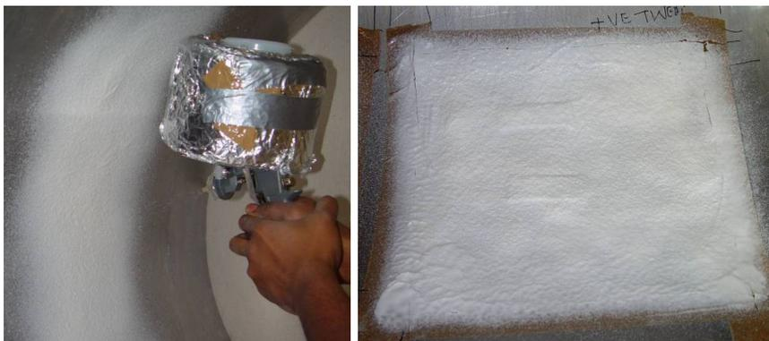
Abb. 4.4.8: Sprühbild einer pneumatischen Becherpistole (links: Zerstäuben der Gelatinelösung mittels Fließbecher-Pistole; rechts: aufgetragene Gelatinelösung, Fläche ca. 40 cm x 40 cm (Gelatine 20%ig, Emulgatorzusatz)
