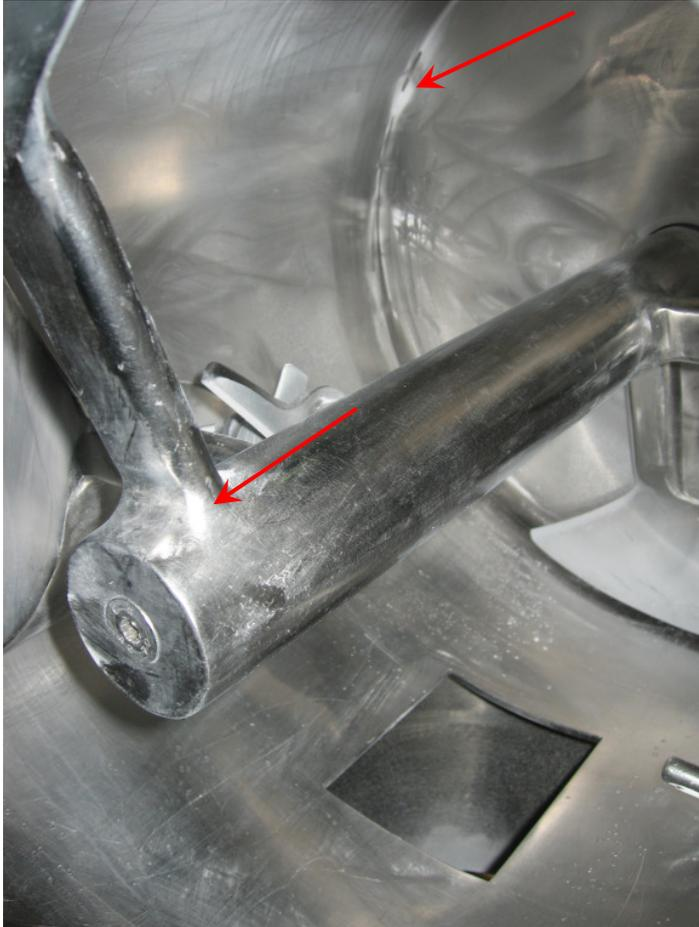
Abb. 4.6.1: Pflugscharmischer nach der Reinigung mit Reinigungszucker
