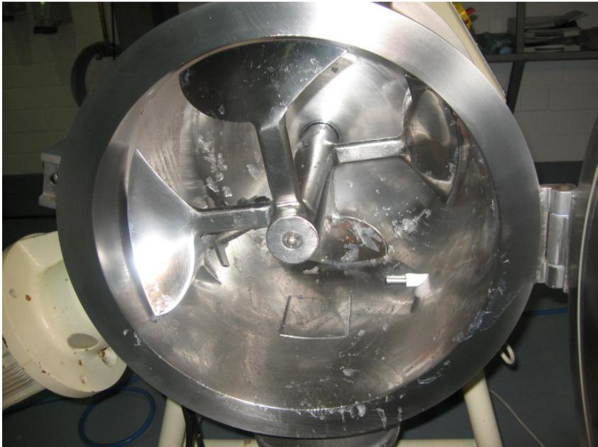
Abb. 4.7.4c: Rückstände nach Ablösen des gelierten Agarfilms aus einem Pflugschermischer
