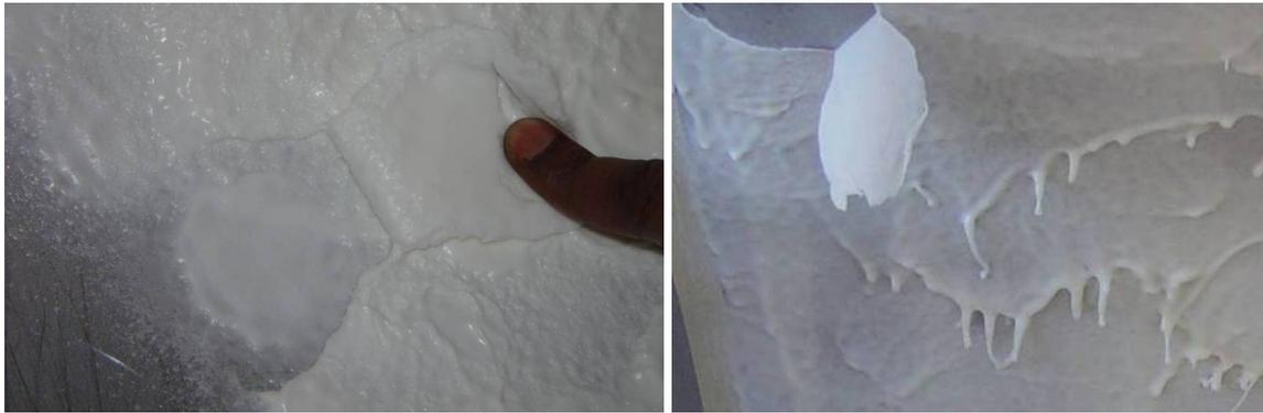
Abb. 4.4.19: Geringe Haftwirkung zwischen Gelatineschichten, rechts: Rinderspaltgelatine aufgetragen bei 50°C
