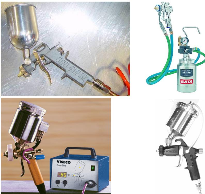
Abb. 4.4.6: Bauformen handelsüblicher Sprühpistolen-Systeme (oben links: Fließbecher-Sprühpistole (Bild IUTA); oben rechts: Druckkessel-Sprühpistole (Fa. SATA GmbH, Kornwestheim); unten links: Sprühpistole mit beheizbarem Becher und Düsenkopf, Temperaturregler (Fa. Viseco GmbH, Aichach); unten rechts: Overspray-reduzierte Sprühpistole (Fa. Metacap GmbH, Lübeck))
