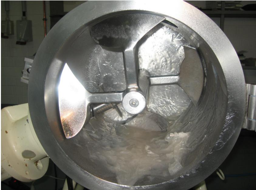
Abb. 4.7.4a: Sprühbild von 1,5%iger Agarlösung nach Aufbringung in einem Pflugscharmischer
