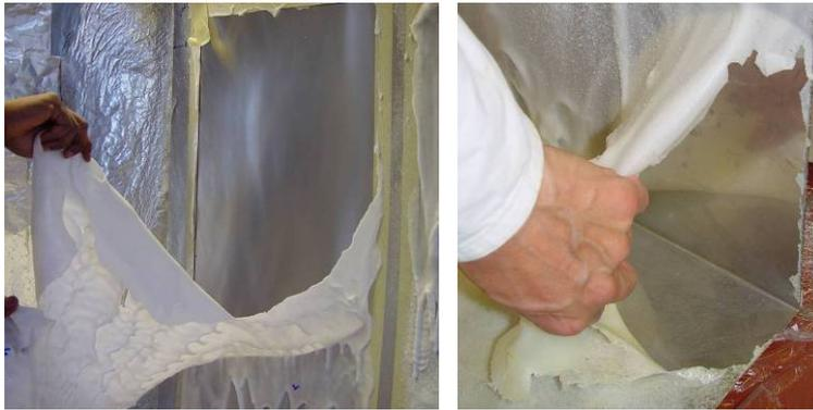
Abb. 4.4.12: Ablösen eines elastischen Gelatinefilms von einer ebenen Testfläche sowie von einer Kante
