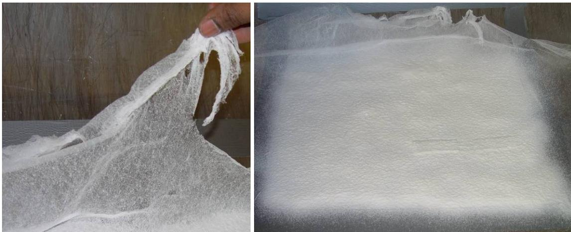
Abb. 4.4.20: Overspray-Effekt und faden- bzw. netzartige Strukturen
