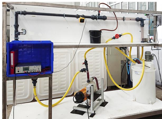
Abb. 3-26: Strömungsapparatur zur Untersuchung der Strömungseinflüsse auf die Probenahme des Messsystems
