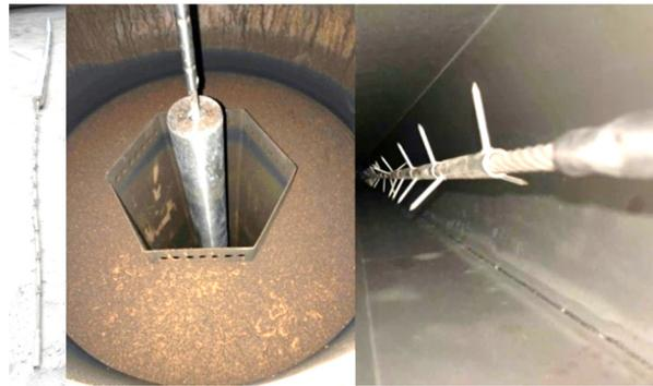
Abb. 3-5: Originale Elektrode (rechts) und optimierte Elektrode (Mitte und links)
