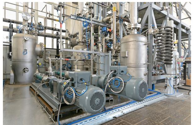
Abb. 3-19: Anlagenerweiterung der Druckgaswäsche
