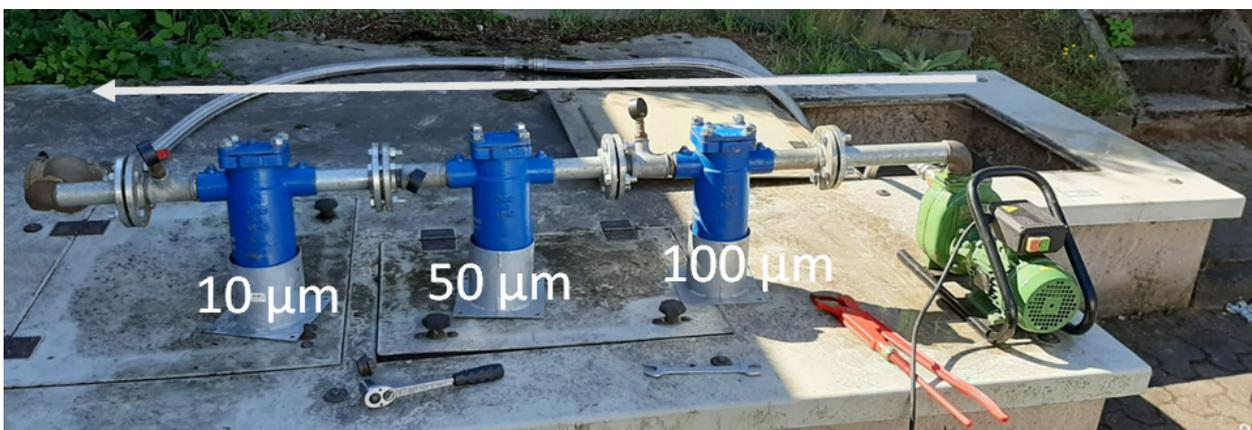
Abb. 3-13: Kaskadische Filtrationsanlage zur Mikroplastikprobenahme
