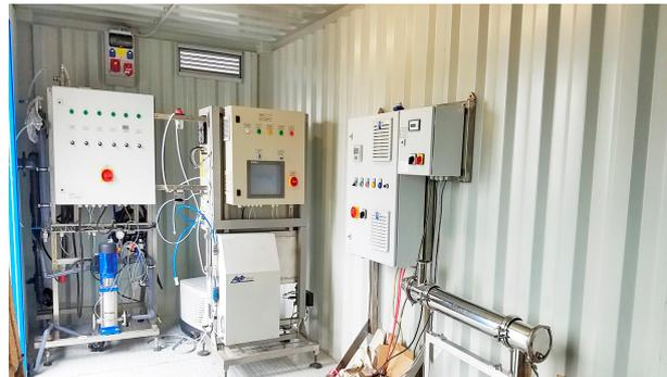
Abb. 3-12: Für den mobilen Einsatz wurde die AOP-Versuchsanlage in einen Container integriert
