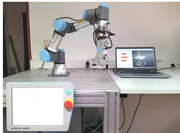
Abb. 3-40: Versuchsaufbau zur Umsetzung zentraler Automationschritte mittels kollaborativer Robotik
