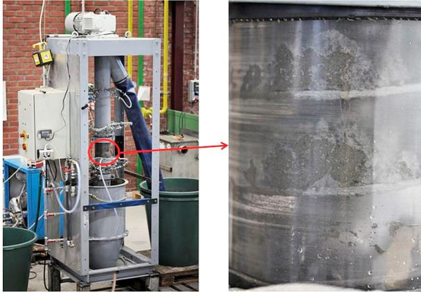
Abb. 3-34: Senkrechtschneckenförderer (links) mit gefördertem Schleifschlamm (rechts)
