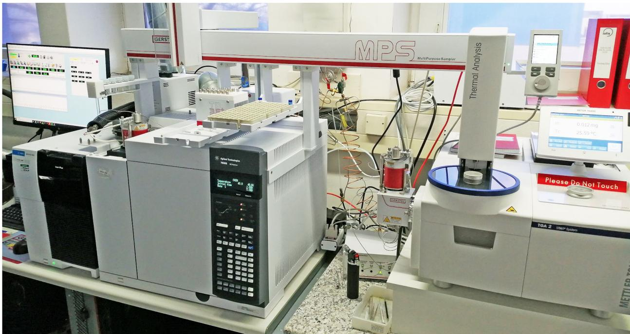
Abb. 3-15: Thermoextraktion-Desorption-Gaschromatografie-Massenspektrometrie (TED-GC-MS) zur Bestimmung von Mikroplastik
