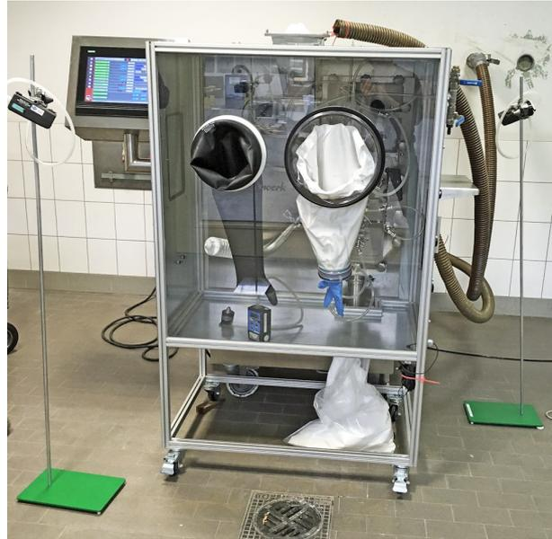
Abb. 3-14: Mobiler Prüfraum zur Anlagenqualifizierung nach OEB 3 – 4 mit Anpassung an die Maschinengeometrie und zwei Handschuhen zum Eingreifen in den Prüfraum während der Messung
