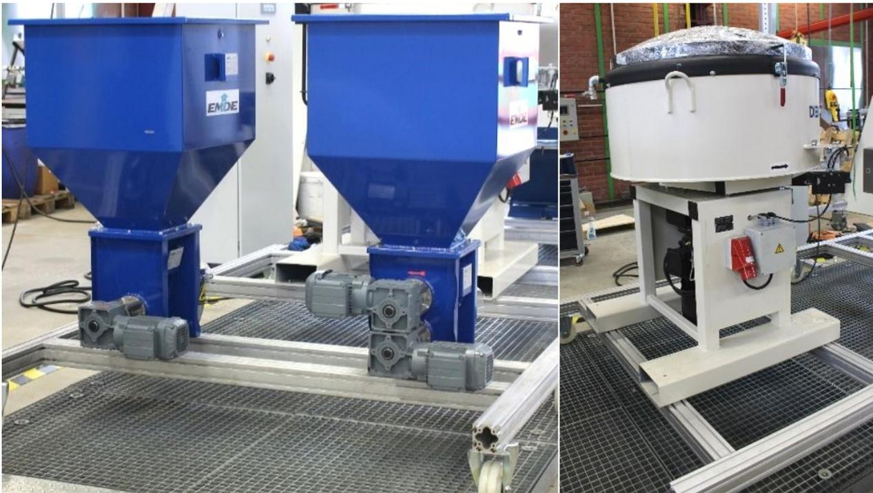
Abb. 3-37: Vorlage-, Dosiereinheit und Mischer an der Universität Duisburg-Essen (Quelle: Entwurf des Abschlussberichtes zum o. g. Forschungsvorhaben)
