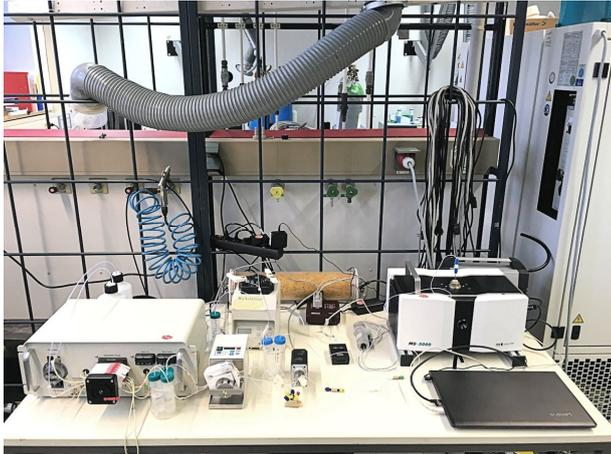
Abb. 3-25: Laboraufbau des ESR-online-Messsystems zur Bestimmung des oxidativen Potentials luftgetragener Partikel
