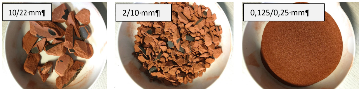
Abb. 3-37: Prüfproben der drei Korngrößenfraktionen
