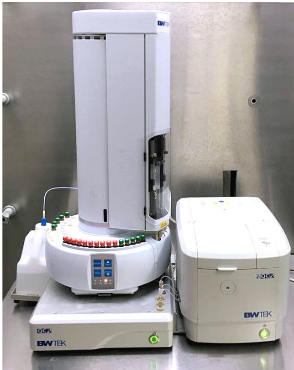
Abb. 3-21: UV-VIS-Raman-Messgerät zur Quantifizierung und Identitätskontrolle von Applikationslösungen
