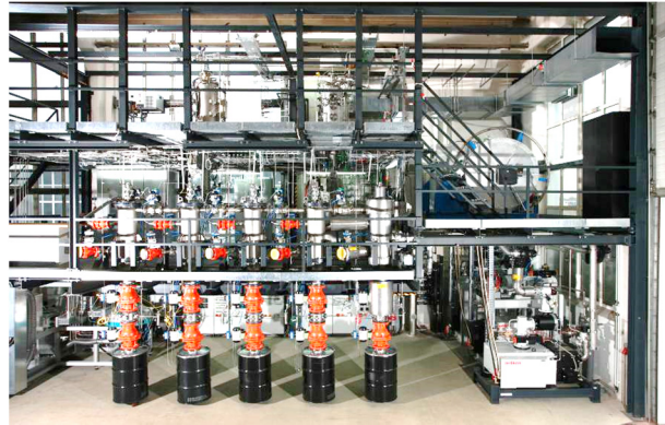
Abb. 3-30: Technikumsanlage zur Herstellung hochspezifischer Nanopartikel
