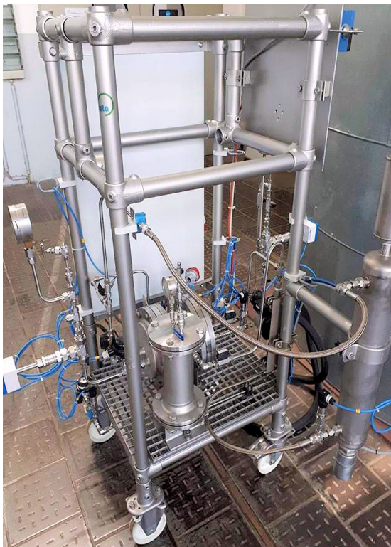
Abb. 3-28: Versuchsanlage Membrantrennverfahren (links); Membranreaktor und Wasservorlage (rechts)
