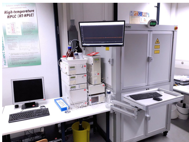
Abb. 3-39: Raman-Detektor gekoppelt mit Flüssigkeitschromatografie
