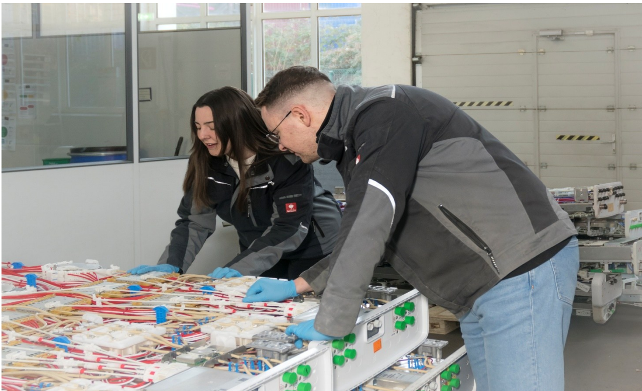
Zerlegung von Mobilfunksendeantennen mit GFK Gehäusen
