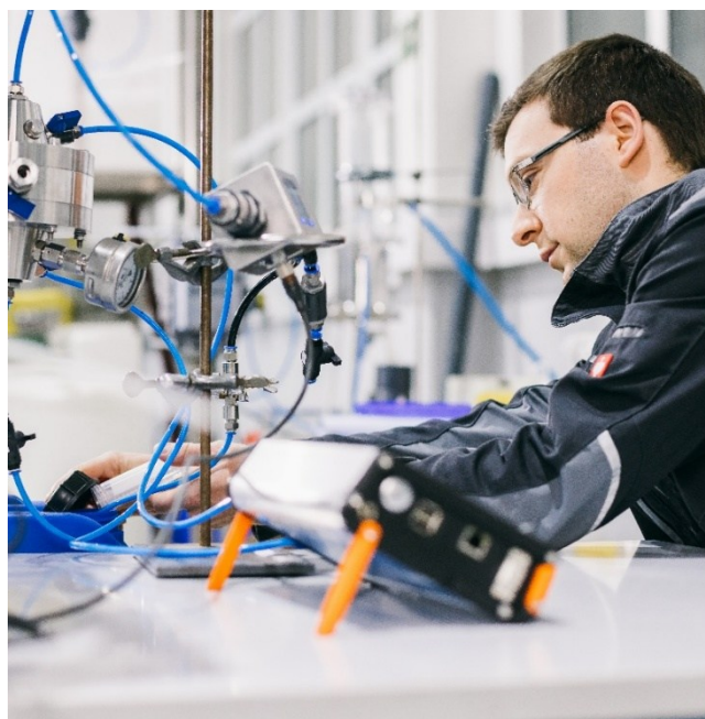
Durchführung von Filtrationstests zur Charakterisierung von Filtergeweben
