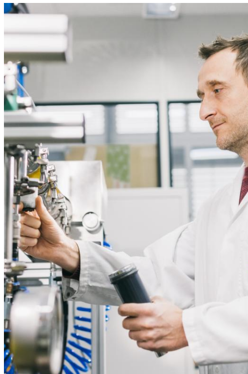
Prüfstand für Druckluftfiltertests nach ISO 12500
