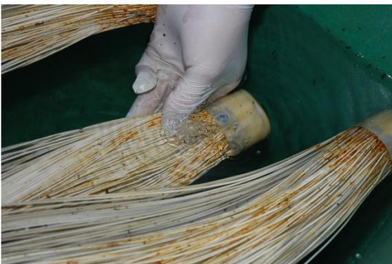
Bild 3-20: Lokalisierung eines Faserbruchs an einem UF-Modul
