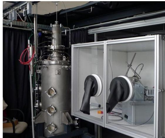
Bild 3-20: Zusammenführung von Pulverförderer, Einhausung und Reaktor
