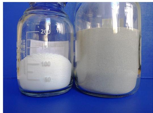
Bild 3-18: Hochspezifische  $\text{TiO}_2$ -Nanopartikel, links: Rußfrei, rechts:  $\text{TiO}_2$  aus Vorversuch mit rußender Flamme
