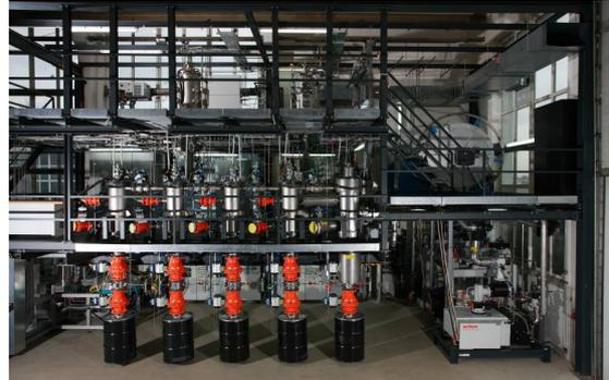
Bild 3-17: Technikums-Anlage zur Herstellung hochspezifischer Nanopartikel
