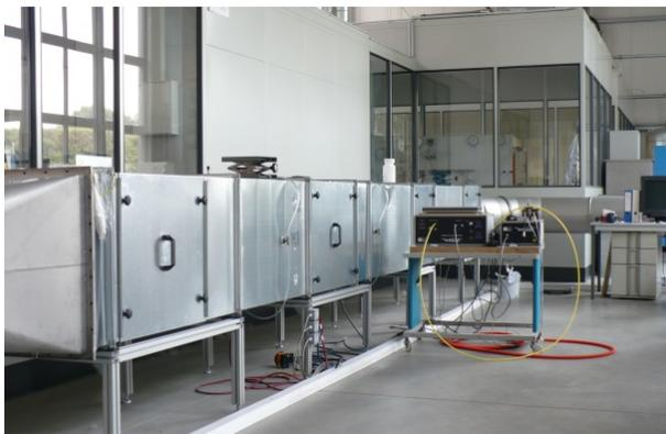
Bild 3-4: Prüfstand nach DIN EN 779
