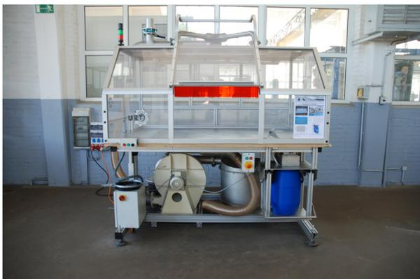
Bild 3-23: Sicherheitswerkbank für die Demontage von Flachbildschirmen
