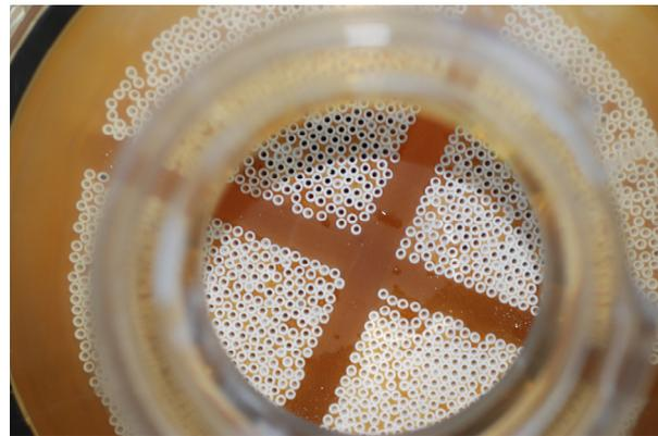
Bild 3-21: Querschnitt eines Ultrafiltrations-Elements
