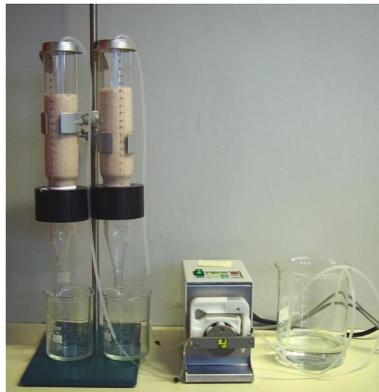
Bild 3-11: *Mobilitätsuntersuchung von TiO<sub>2</sub> Nanomaterialien in bodenähnlichen Substraten (hier Quarzsand) basierend auf die OECD Richtlinie 312*
