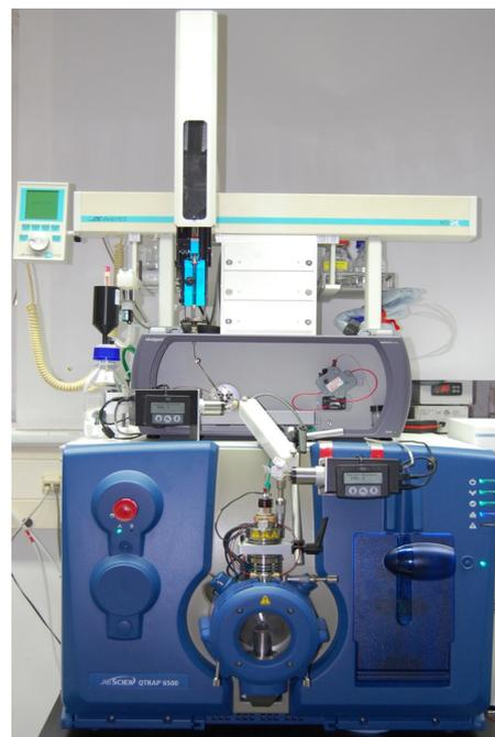
Bild 3-13: Neues Tandemmassenspektrometer ( $\mu\text{LC-MS/MS}$ ) zur Spurenanalyse
