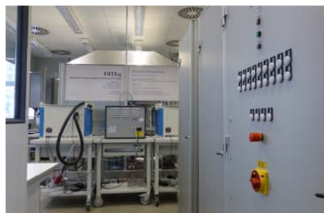
Bild 4-6: Adsorptionsprüfstand mit PTR-MS-System
