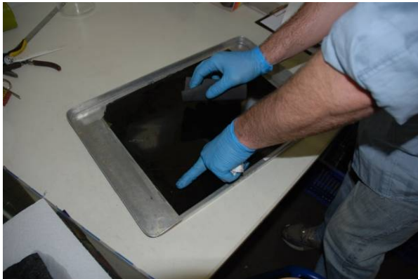
Bild 4-77: Abschleifversuch mit einem Schleifvlies
