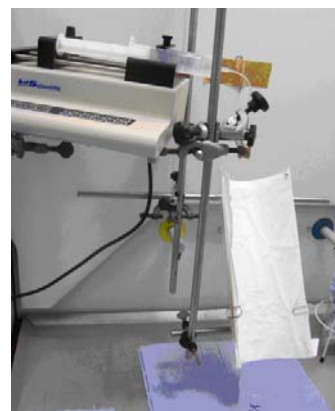
Bild 4-45: Prüfaufbau nach DIN EN ISO 6530 (Dachrinnen-test)
