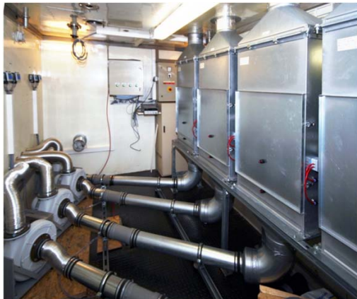
Bild 4-29: Prüfstand zur Filter-Beladung aus der Außenluft mit vier separaten Messstrecken - Innenansicht
