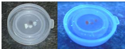
Bild 4-66: Thermisch behandeltes Si:SiO 2 unter Tageslicht (links) und unter UV-Licht (rechts)
