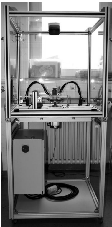
Bild 4-34: Bestimmung der Freisetzung von Nanomaterialien beim Schleifen
