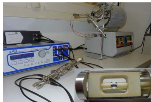
Bild 4-69: Impedanzmessplatz zur Charakterisierung von Silizium-basierten thermoelektrischen Generatoren. Vergrößerung: Neu konstruierte und gebaute Messzelle mit eingebautem nanostrukturiertem Siliziumquader.
