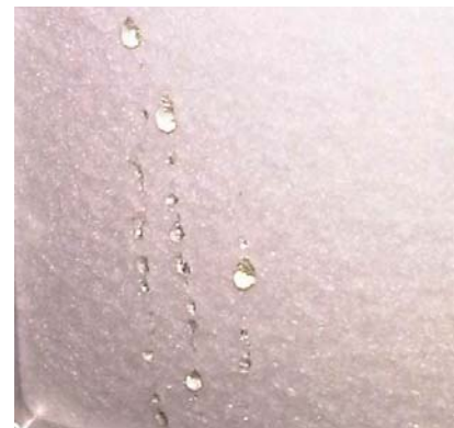
Bild 4-14: Tropfenbildung an der Abströmseite des phobisierten Nadelfilzes
