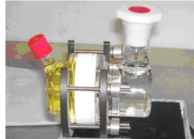
Bild 4-44: Permeationszelle nach DIN EN ISO 6529 (1) Kleine Glas-Kammer für Prüfchemikalie (2) Halterung für Probematerial, Versuchsfläche: 19,6 cm 2 (3) Große Glas-Kammer für das Sammelmedium mit Rührer
