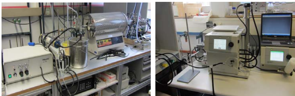
Bild 4-24: Der Agglomerat-Versuchsaufbau: Links: Agglomerat/Aggregat-Erzeugungsanlage; rechts: Gitter/Filterprüfstand
