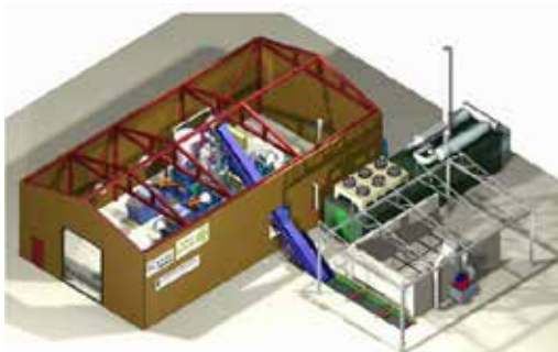
Bild 4-51: links: Schnitzzeichnung durch die Holzvergaseranlage in Arnsberg-Wildshausen mit Gasmotoren-BHKW rechts: Foto der Holzvergaseranlage in Arnsberg-Wildshausen
