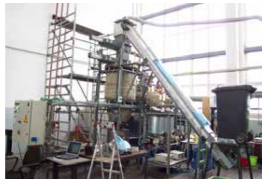
Bild 4-49: Schnittzeichnung des IUTA Gegenstromvergasers (links) und Foto der Technikumsanlage (rechts)
