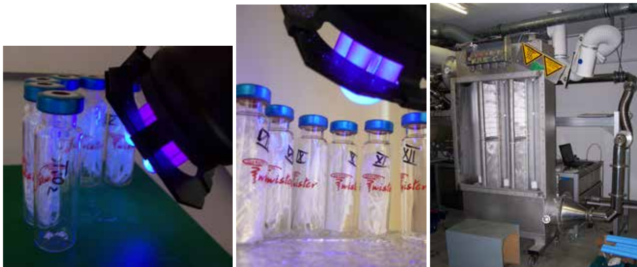
Bild 4-46: links und mittig: Vorversuche zur katalytischen Aktivität der neuen Filter im Labor rechts: Filterprüfstand mit Filtermaterial und UV-Lampen im Photoreaktor
