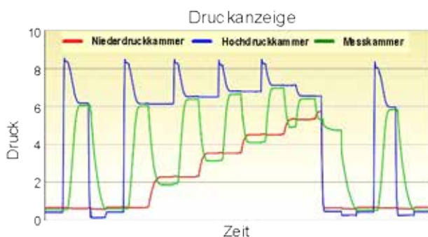
Bild 4-58: Druckverläufe in der Mess-, Hoch- und Niederdruckkammer bei einem 5 Zyklen umfassenden Messdurchlauf
