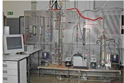
Bild 4-52: Technikumsanlage zur Untersuchung der pottaschebasierten \text{CO}_2 -Wäsche
