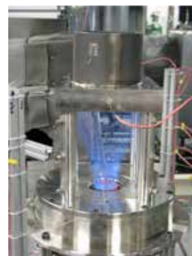
Bild 4-50: Turbec T100. links: Mikrogasturbinenprüfstand des DLR, mitte: Optisch zugängliche Brennkammer des Mikrogasturbinenprüfstands, rechts: Atmosphärischer Einzelbrennerprüfstand
