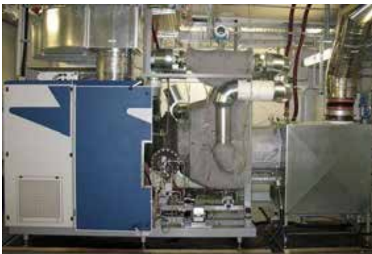
Bild 4-50: Turbec T100. links: Mikrogasturbinenprüfstand des DLR, mitte: Optisch zugängliche Brennkammer des Mikrogasturbinenprüfstands, rechts: Atmosphärischer Einzelbrennerprüfstand
