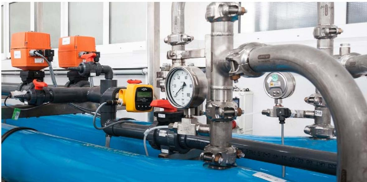
*Versuchsanlage für 8" Membranmodule*
