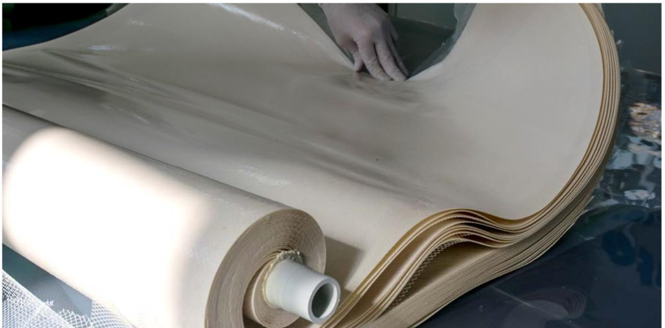
*Begutachtung der Membranoberfläche eines zerlegten Umkehrosmosemoduls*
