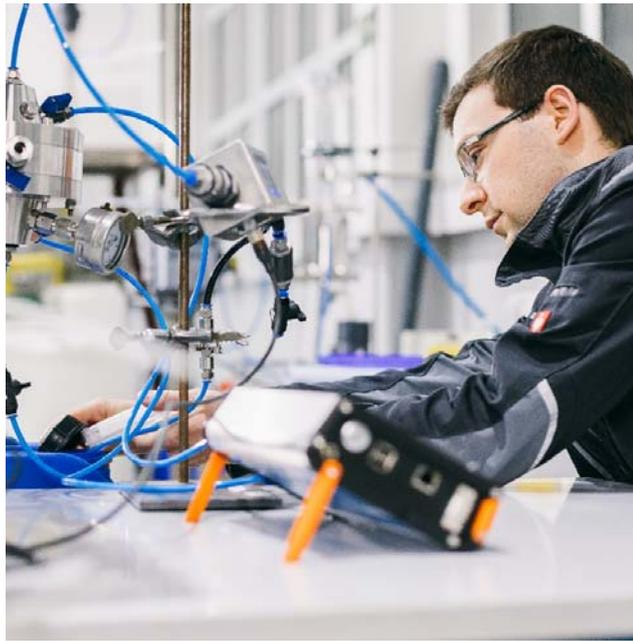
*Durchführung von Filtrationstests im Vorfeld der Ballastwasseranalytik*
