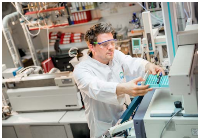
Probengeber eines LC-MS-Systems in einem Labor des IUTA-Bereichs Forschungsanalytik
