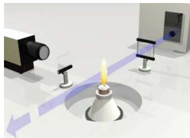
Typischer Aufbau für die bildgebende laserinduzierte Fluoreszenz
